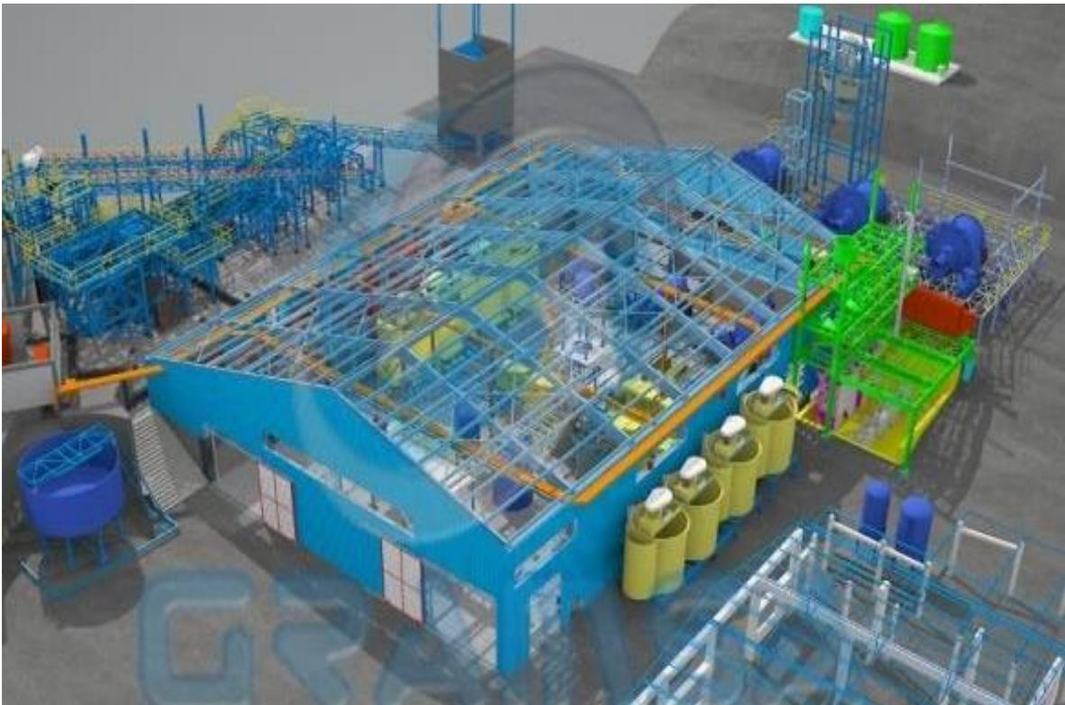
*Figura 5.* Ingeniería de detalle, proyecto planta de beneficio “Untuca” – Minera Cori Puno, Puno. Perú.
