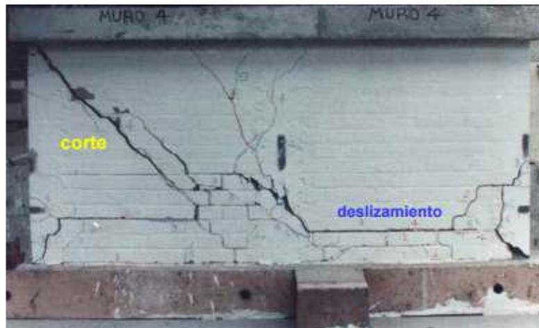
*Figura N° 8: Falla por corte, debido a la tracción diagonal y deslizamiento (San Bartolomé).*
