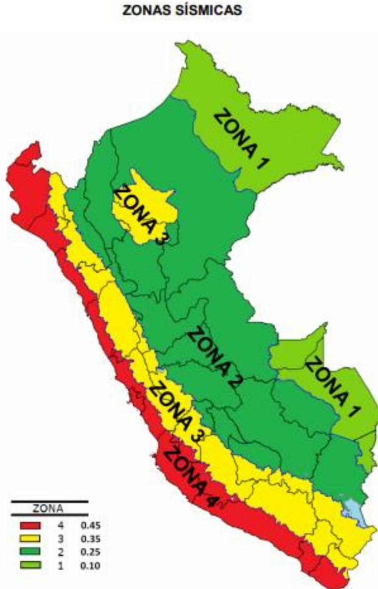
*Figura N° 5: Zonificación sísmica del Perú*
