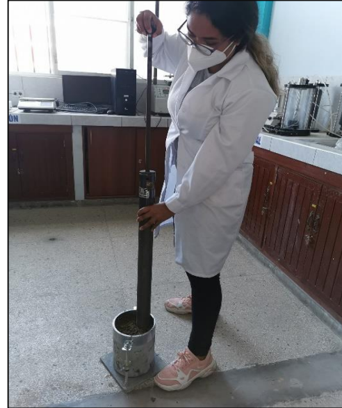
Compactación del material en el ensayo de CBR.
