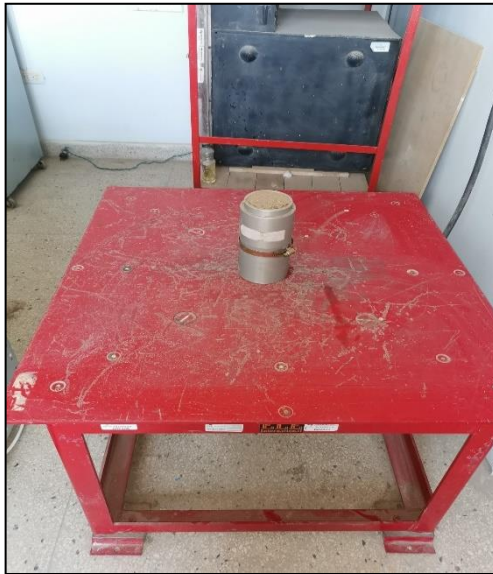
Ensayo de densidad relativa en mesa vibratoria.
