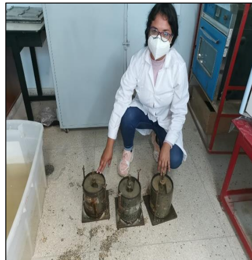
Probetas después de haber sido sumergidas en el agua para luego ser ensayadas en la máquina de CBR.
