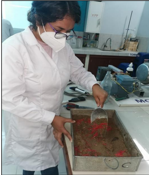
Preparación del material con las fibras para realizar la compactación en el ensayo de CBR.
