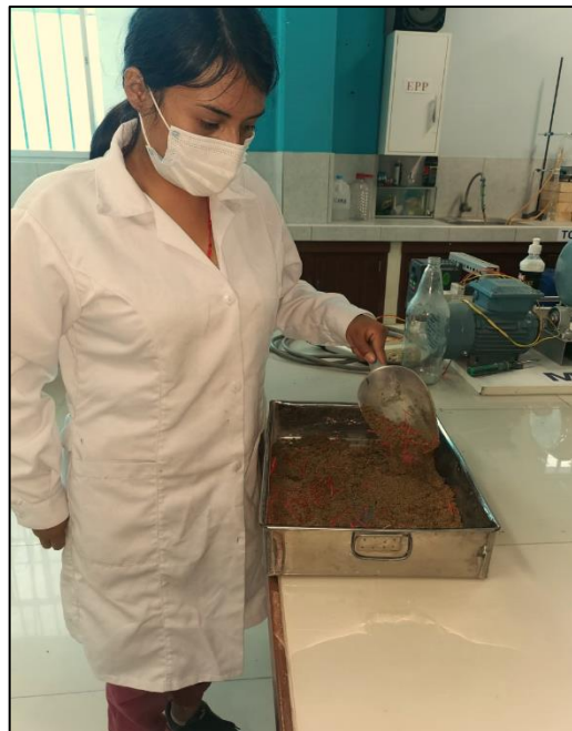
Mezclado del material con fibras PET para realizar el ensayo de Densidad Relativa.
