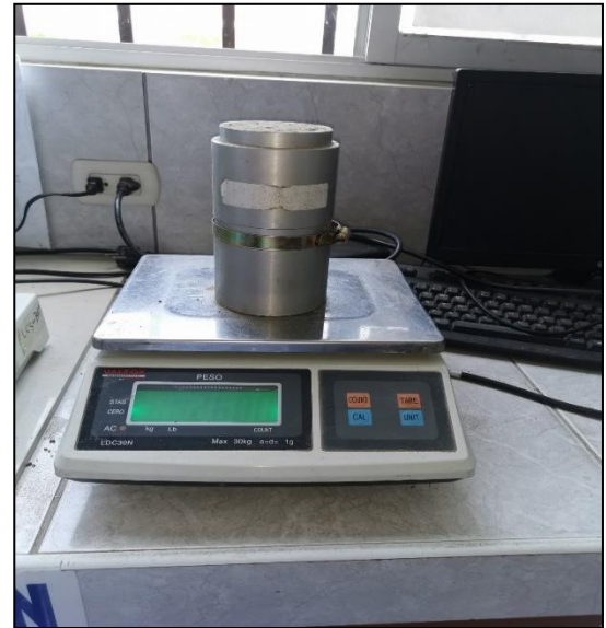
Peso del material en el ensayo de densidad Relativa.
