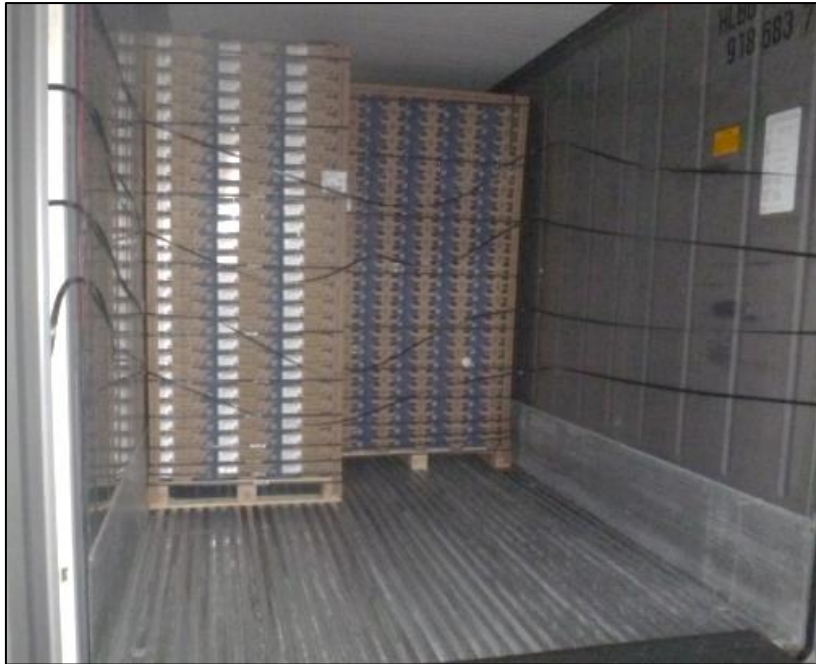
Anexo N°13: Zunchos listos para el trincado.
