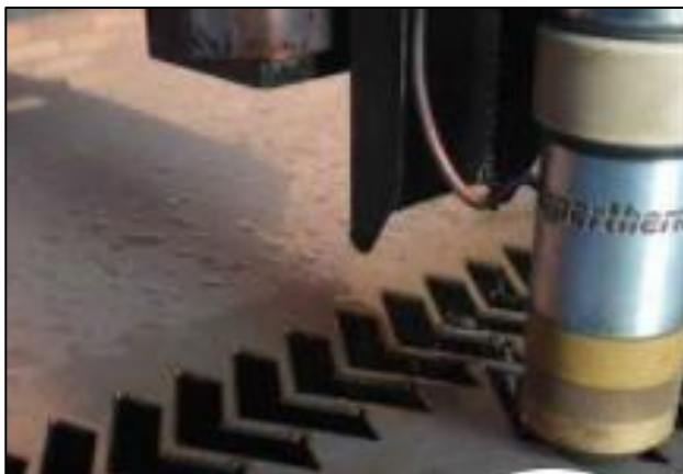
Figura 6. Trabajos de corte CNC plasma.
