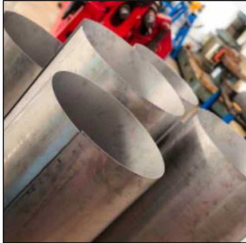
Figura 5. Rolado hidráulico de planchas metálicas.
