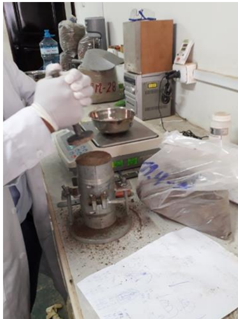
Figura 49. Compactación de espécimen con NaCl Fuente: Propia
