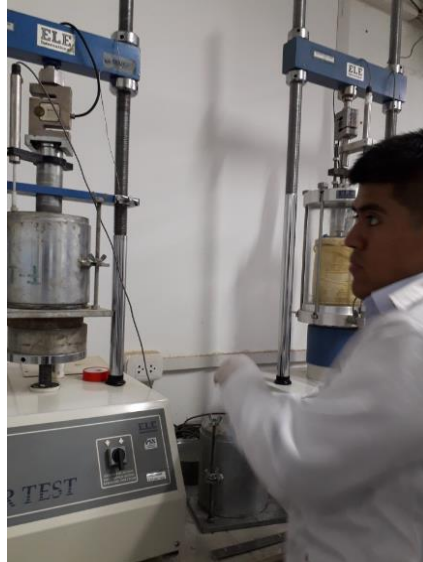
Figura 42. Se procede a iniciar la penetración Fuente: Propia
