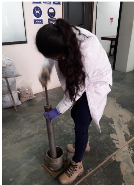
Figura 66. Compactación de espécimen. Fuente: Propia.
