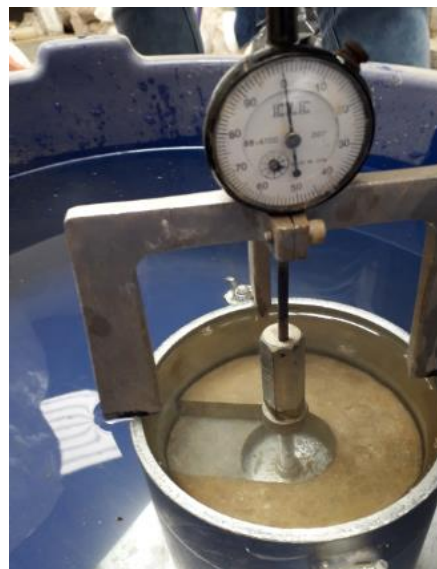
Figura 40. Inmersión en pozo de curado Fuente: Propia
