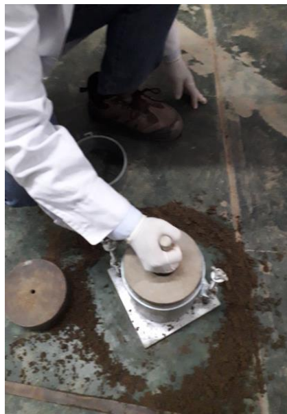
Figura 38. Se coloca la pesa anular y ranurada Fuente: Propia
