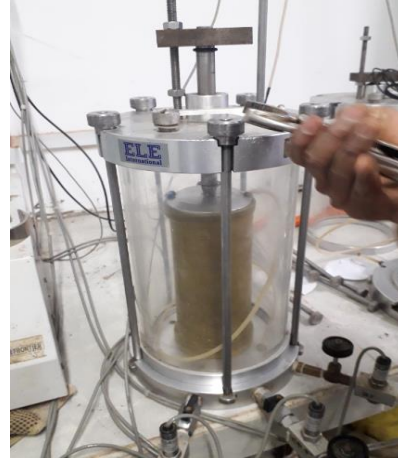
Figura 77. Verificación de verticalidad y llenado de agua Fuente: Propia
