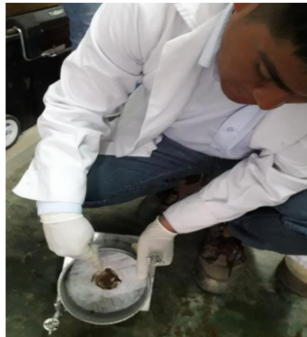
Figura 43. Muestra para cálculo del contenido de humedad Fuente: Propia
