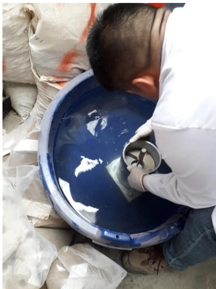
Figura 106. Inmersión en tanque de curado Fuente: Propia
