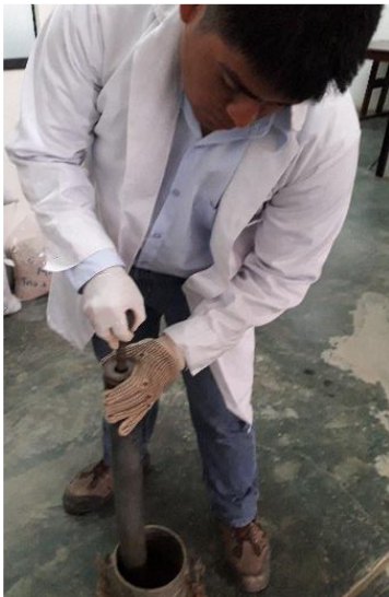
Figura 102. Apisonado de material Fuente: Propia
