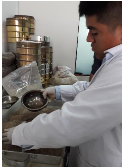
Figura 34. Mezcla de NaCl, agua y suelo Fuente: Propia
