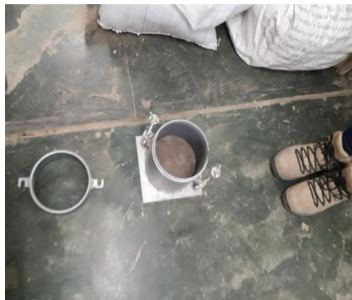
Figura 64. Ensamblaje de molde y collarín. Fuente: Propia.
