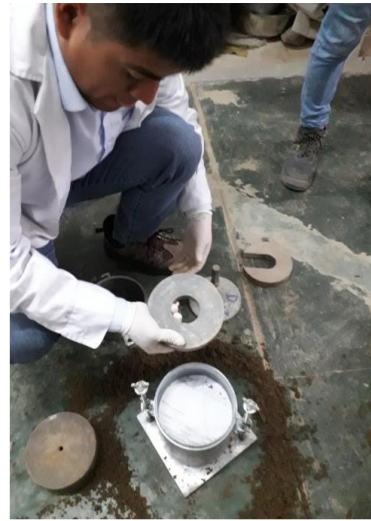
Figura 101. Ensamblaje de probeta Fuente: Propia
