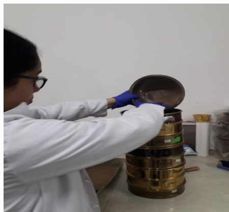
Figura 32. Tamizado Fuente: Propia
