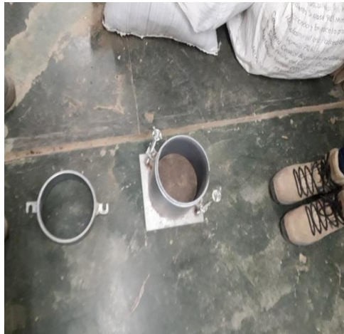
Figura 35. Colocación del collarín y el disco espaciador Fuente: Propia
