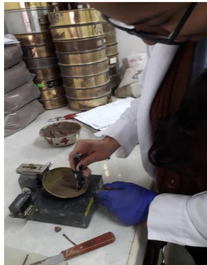
Figura 26. Trazado de ranura vertical. Fuente: Propia
