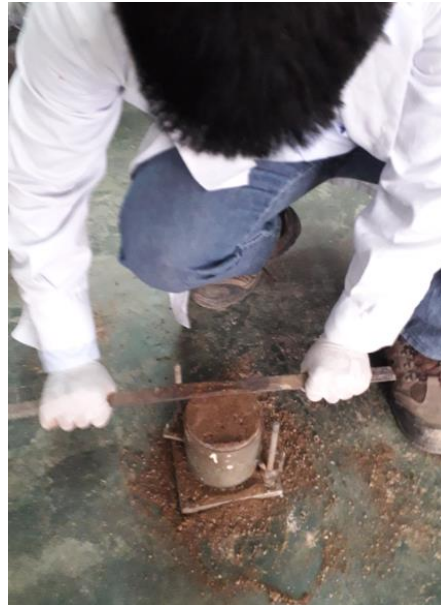
Figura 37. Se procede a enrasar Fuente: Propia
