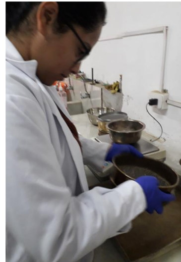
Figura 103. Tamizado de material Fuente: Propia
