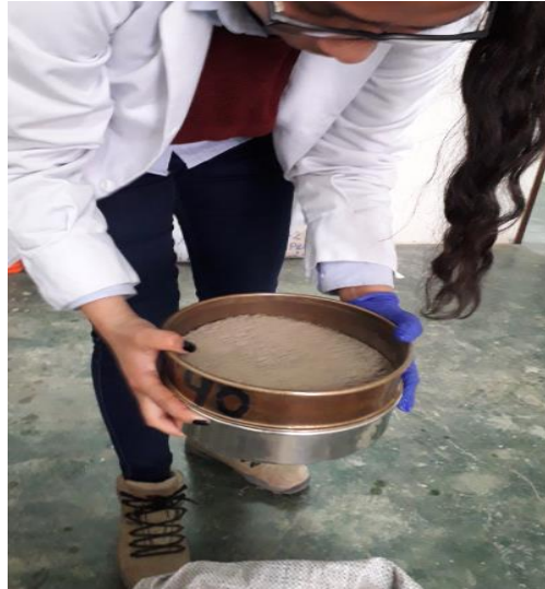
Figura 20. Tamizado de material arcilloso. Fuente: Propia
