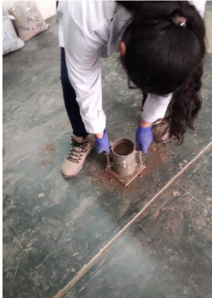
Figura 67. Remoción del collarín. Fuente: Propia
