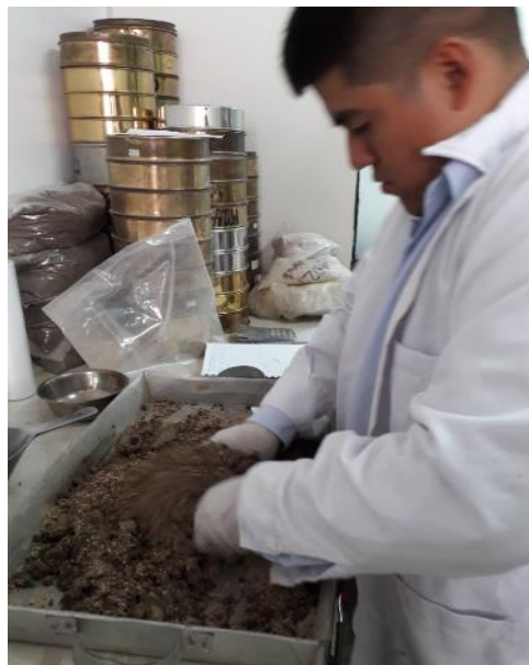
Figura 62. Mezcla de muestra, agua y NaCl. Fuente: Propia
