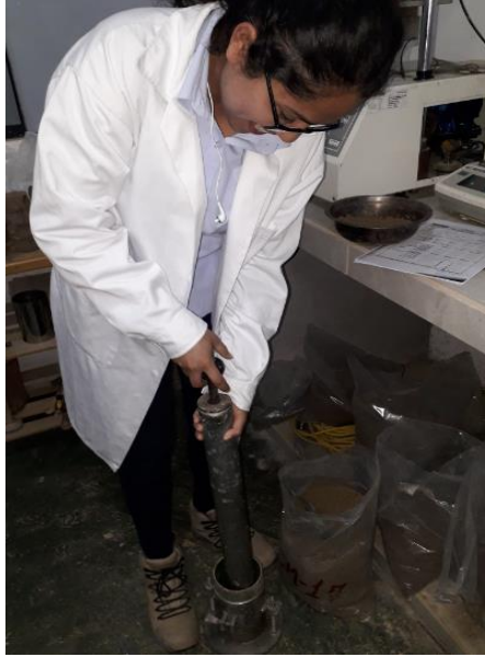
Figura 75. Compactación de muestra Fuente: Propia
