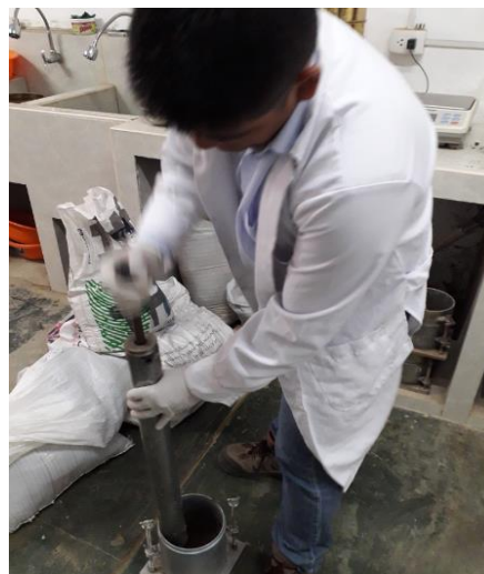
Figura 36. Compactación del espécimen Fuente: Propia
