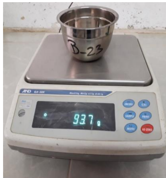
Figura 21. Registro de peso húmedo y tara. Fuente: Propia
