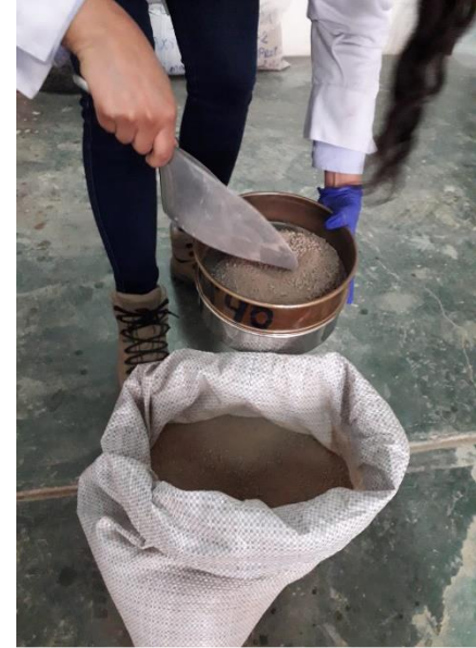
Figura 105. Tamizado para pruebas Fuente: Propia
