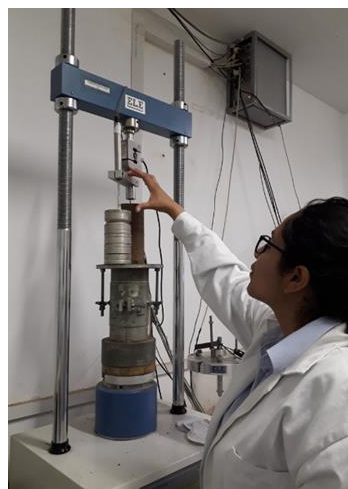
Figura 51. Se coloca la probeta en la prensa Fuente: Propia
