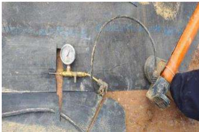
Figura 23. Pruebas de Control de Calidad Geomembrana Fuente: BISA (2018)
