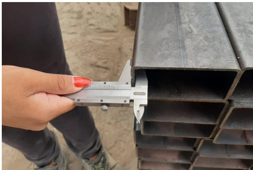
Figura 43. Verificación de material
