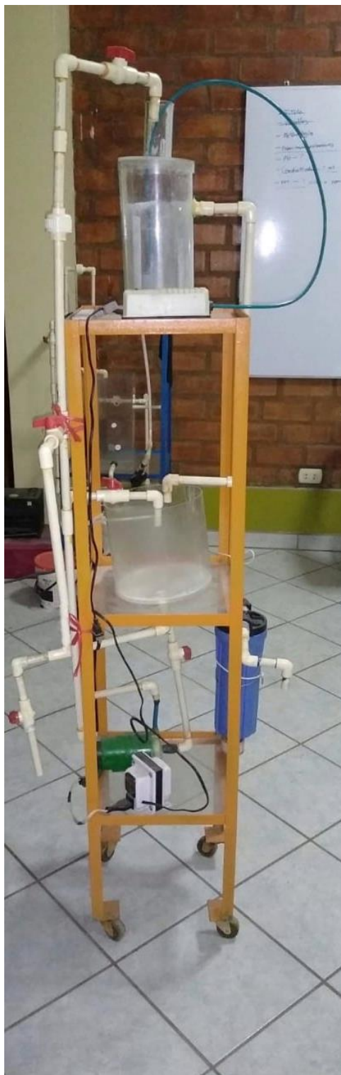
Figura 24. Módulo y Estructura de Electrocoagulación. Fuente: Elaboración propia.
