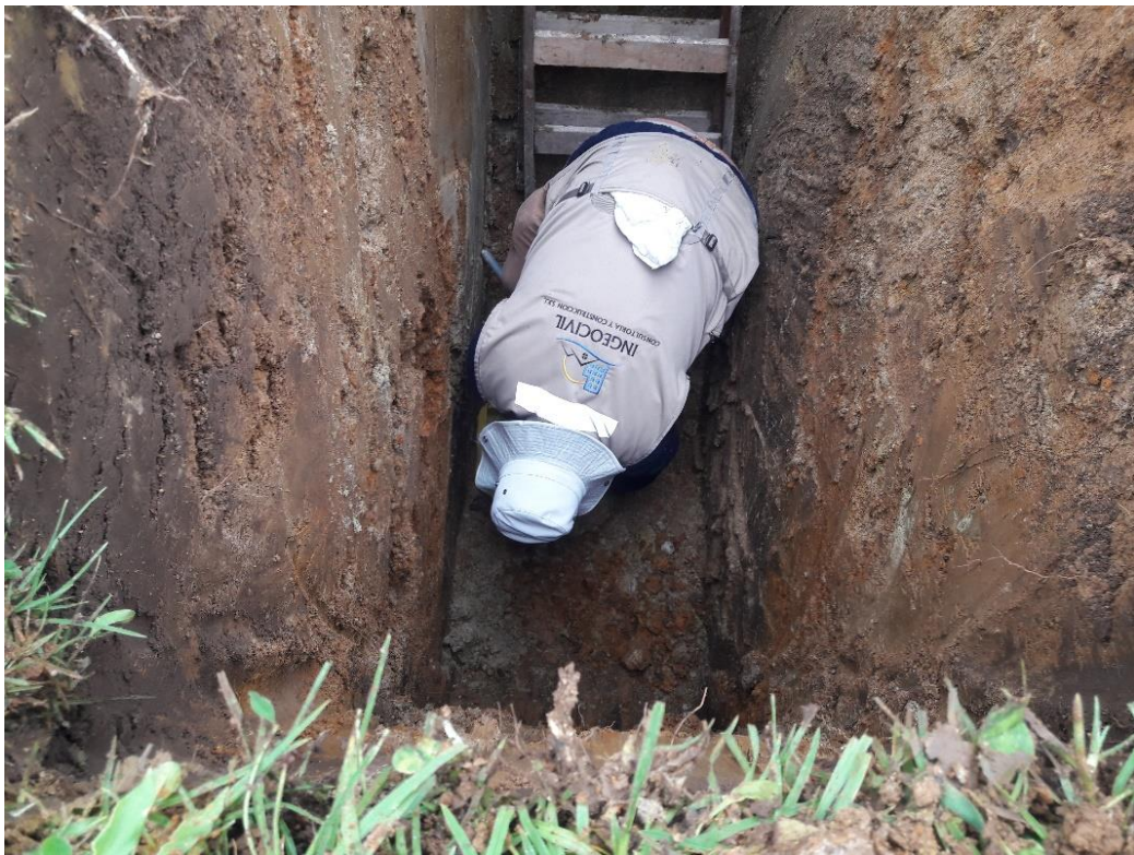
Figura 4 Toma de muestras de suelo de cada estrato identificado a profundidad en la calicata C-11.
