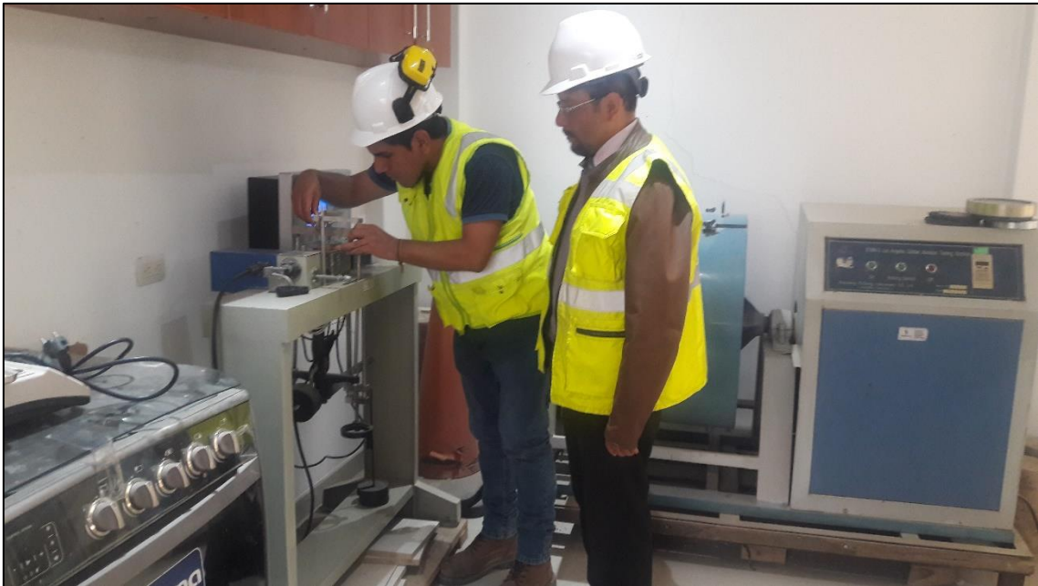
Figura 12 Ensayo de corte directo realizado en el Laboratorio de Mecánica de Suelos, Concreto y Pavimentos “WFM”, ubicado en la Urb. De los Docentes UNC H-3 Cajamarca.
