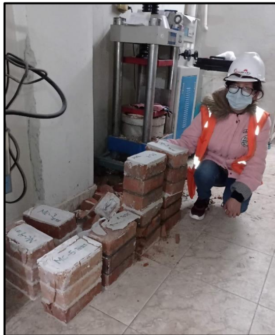
Figura 51. Pilas de albañilería después de ensayo a compresión.
