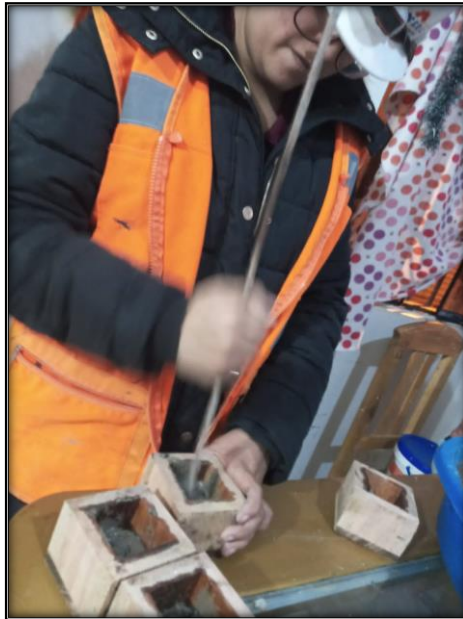
Figura 47. Compactado del mortero tradicional P1 en el molde.
