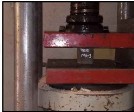
Figura 22. Prueba a compresión de cubos de mortero 1:3 (5cm x 5cm x 5cm).
