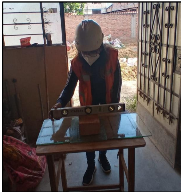
Figura 43. Colocación de Camping de yeso a la unidad de ladrillo.
