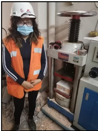
Figura 15. Máquina para el ensayo a compresión marca Yufeng.
