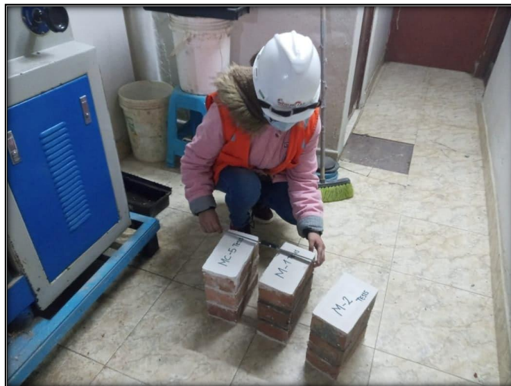
Figura 49. Pilas de albañilería para ensayo a compresión.
