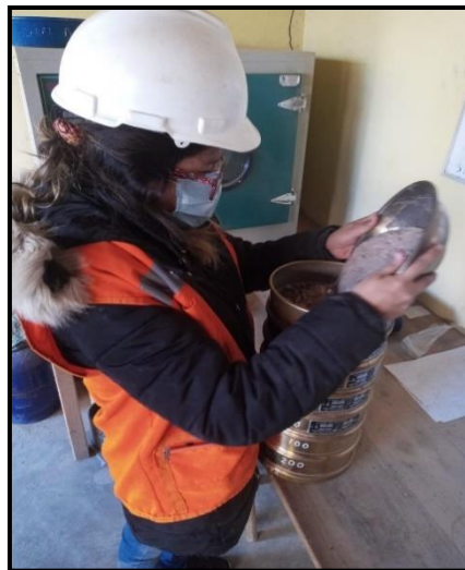
Figura 21. Colocación del agregado fino en los tamices.
