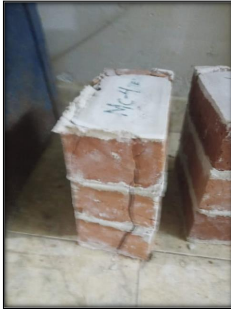
Figura 50. Pila de albañilería después de la falla en máquina de compresión.
