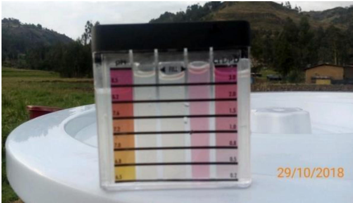
Figura 40. Ensayo de DPD del agua filtrada y clorada en el tanque de almacenamiento.
