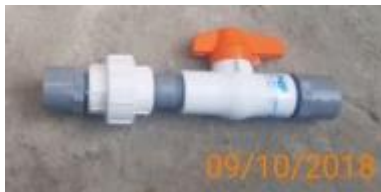
Figura 14. Tubería de ingreso al tanque dosador.
