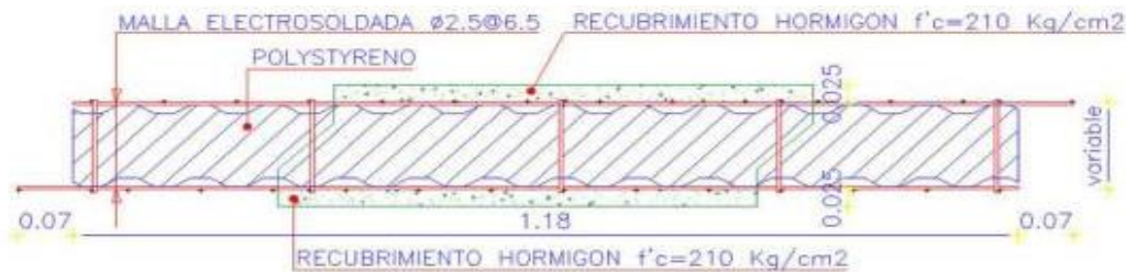
Figura 12. Panel simple estructural (PSME). Hormi2, 2013
