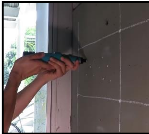
Figura 44. Ensayo de esclerómetro. Fuente: UNCM, 2019
