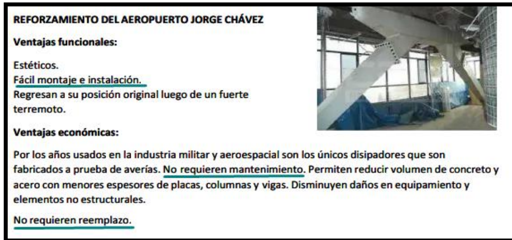
Figura 112. Reforzamiento del aeropuerto Jorge Chávez. Fuente: Arq. Pinto, 2015
