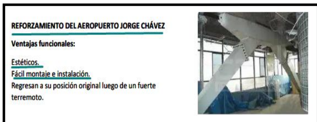
Figura 90. Disipadores en el aeropuerto Jorge Chávez. Fuente: CDV Representaciones, s.f.
