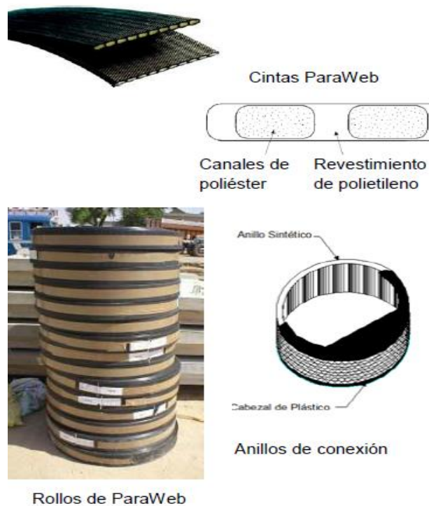
Figura 43. Sistema de Refuerzo ParaWeb Fuente: Maccaferri – América Latina
