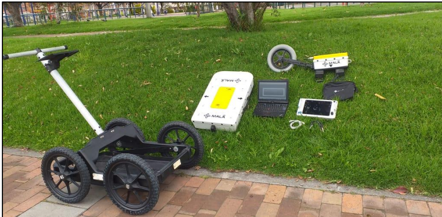
Figura 7 Georradar de la casa MALA. Propiedad de la empresa ITINERIS PERU S.A Fuente: Elaboración propia
