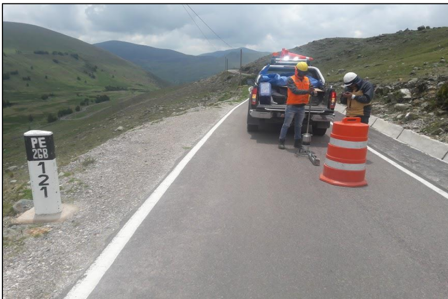
Figura 22 Trabajos de deflectometría Liviana en el tramo Lircay - Ayacucho para la empresa Geoconsult Ingenieros Fuente: Elaboración propia
