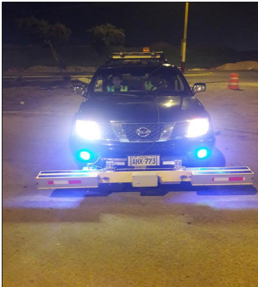
Figura 28 Evaluación funcional (IRI) mediante el perfilómetro laser en la Av. Santa Rosa – Callao Fuente: Elaboración propia
