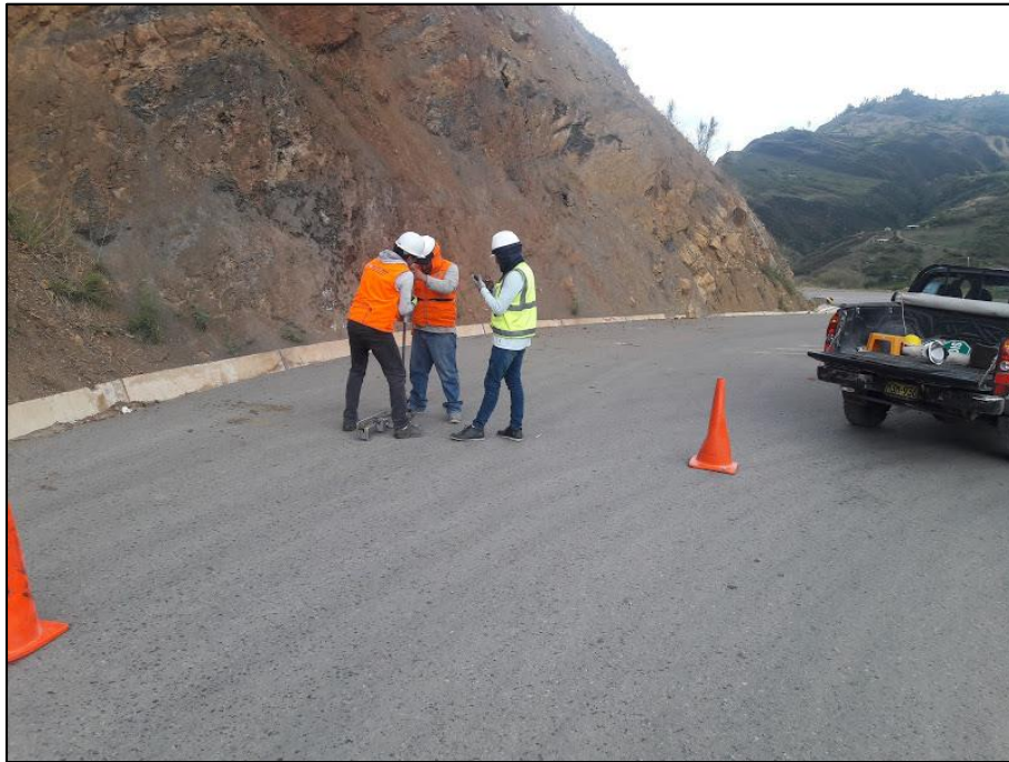
Figura 11 Trabajos de deflectometría Liviana en el tramo Puente Cumbil – Santa Cruz para Geoconsult Fuente: Elaboración propia
