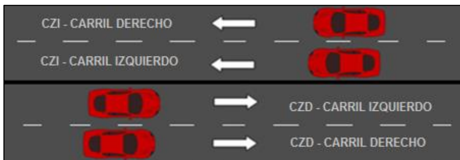
Figura 68 Definición de carriles para el tramo 2 calzada izquierda (CZI) y calzada derecha (CZD) Fuente: Elaboración propia
