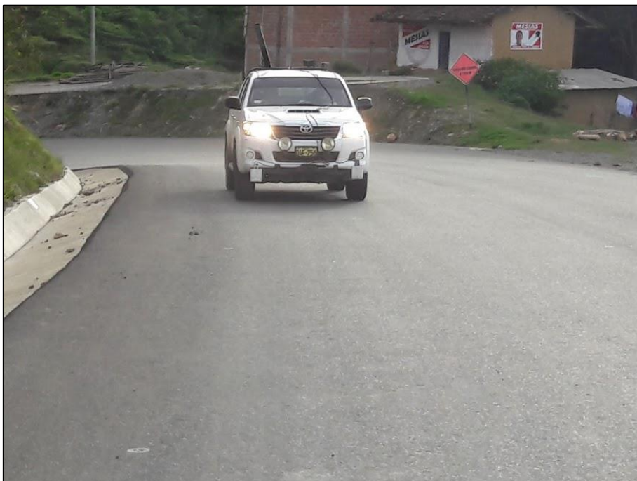
Figura 16 Trabajos de evaluación funcional (IRI) mediante el perfilómetro laser en el tramo Cochabamba – Cutervo para Geoconsult Ingenieros y Consultores. Fuente: Elaboración propia
