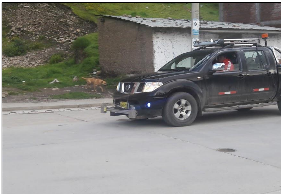
Figura 38 Evaluación funcional mediante Perfilómetro laser IRI en pavimento asfaltico Fuente: Elaboración propia
