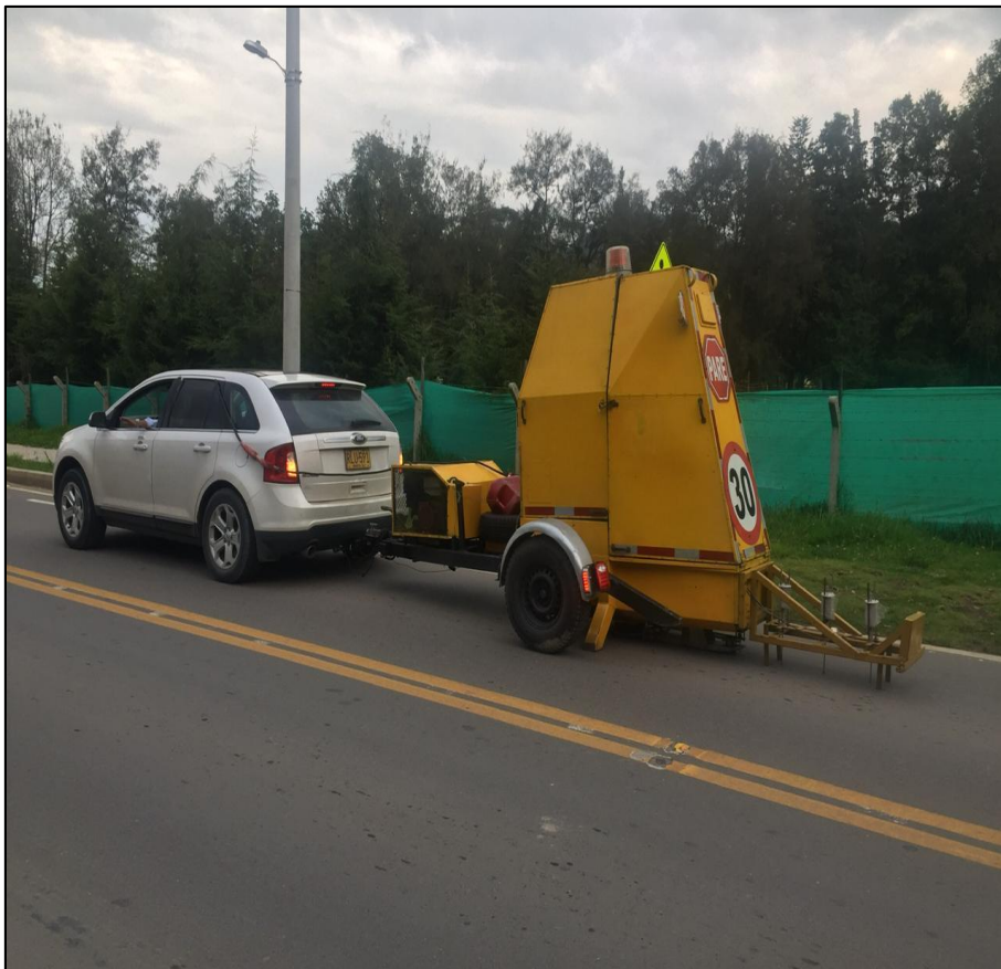
Figura 3 Imagen del deflectómetro FWD. Propiedad de la empresa ITINERIS PERU S: A Fuente: Elaboración propia
