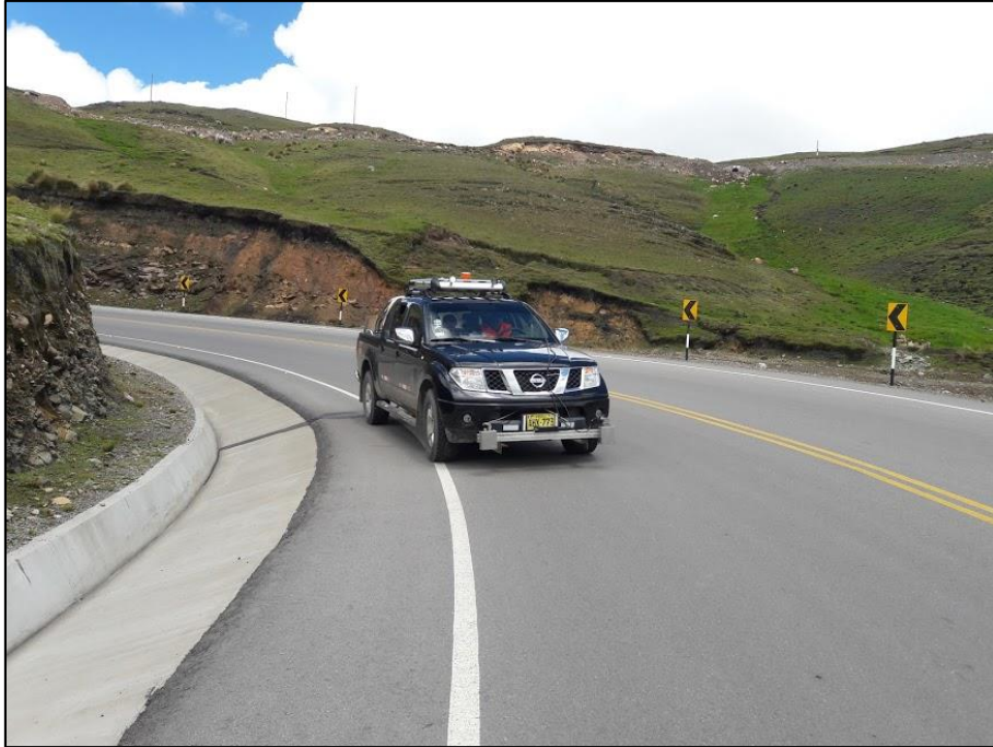
Figura 25 Trabajos de evaluación funcional (IRI) mediante el perfilómetro laser en el tramo Huancavelica – Lircay para la empresa Geoconsult Ingenieros Fuente: Elaboración propia
