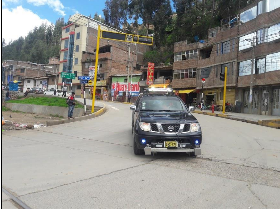
Figura 27 Trabajos de evaluación funcional (IRI) mediante el perfilómetro laser en el tramo Huancavelica – Lircay para la empresa Geoconsult Ingenieros Fuente: Elaboración propia
