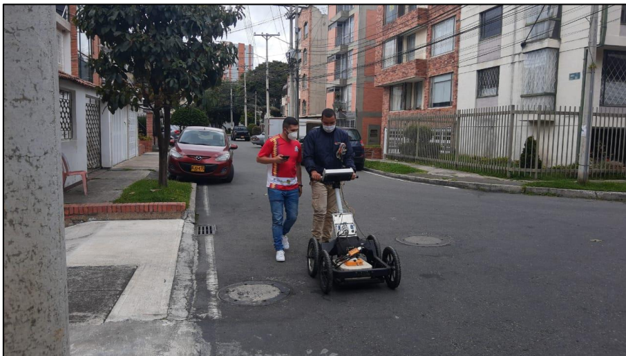
Figura 8 Desarrollo del trabajo de campo del Georradar de la empresa ITINERIS PERU S.A Fuente: Elaboración propia
