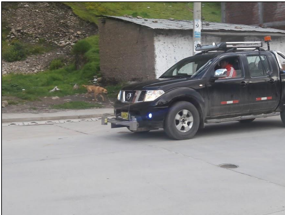
Figura 26 Trabajos de evaluación funcional (IRI) mediante el perfilómetro laser en el tramo Huancavelica – Lircay para la empresa Geoconsult Ingenieros Fuente: Elaboración propia
