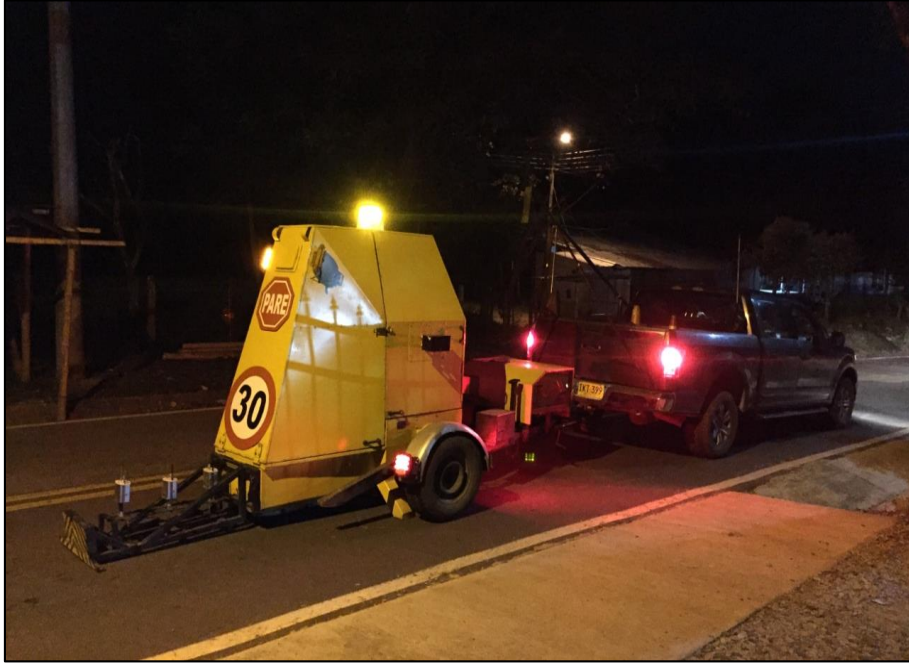
Figura 36 Deflectometro de impacto FWD en pavimento asfaltico Fuente: Elaboración propia
