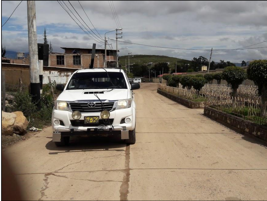
Figura 15 Trabajos de evaluación funcional (IRI) mediante el perfilómetro laser en el tramo Puente Cumbil – Santa Cruz para Geoconsult. Fuente: Elaboración propia
