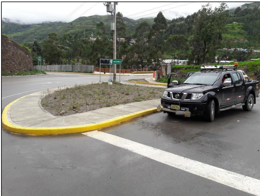
Figura 28 Trabajos de evaluación funcional (IRI) mediante el perfilómetro laser en el tramo Huancavelica – Lircay para la empresa Geoconsult Ingenieros Fuente: Elaboración propia
