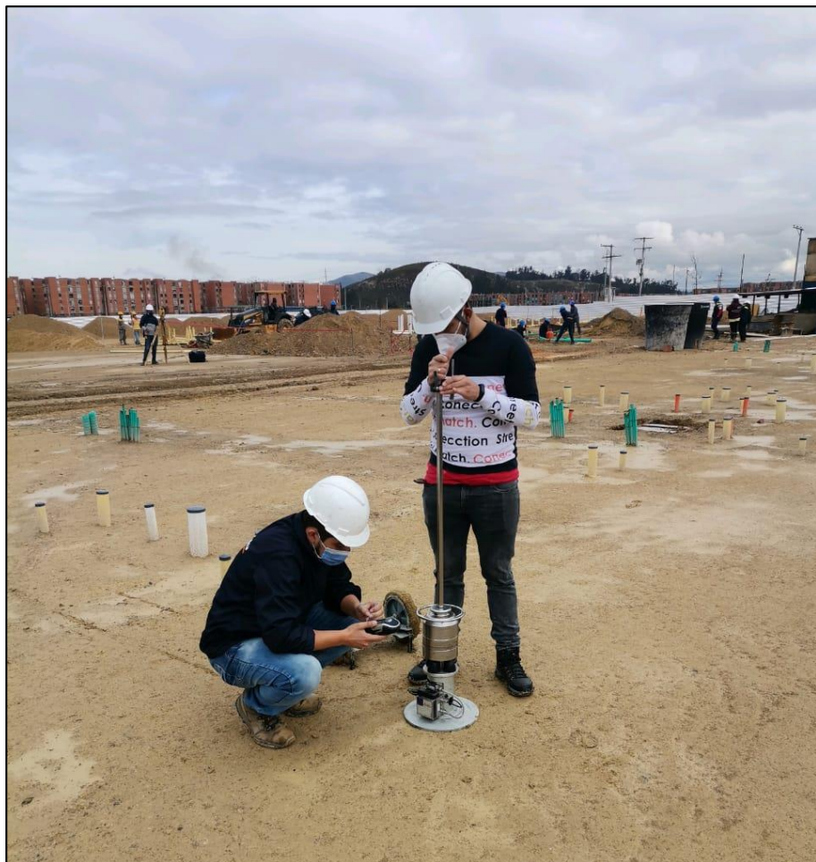
Figura 4 Imagen del deflectometro liviano de impacto LWD. Propiedad de la empresa ITINERIS PERU S: A. Fuente: Elaboración propia
