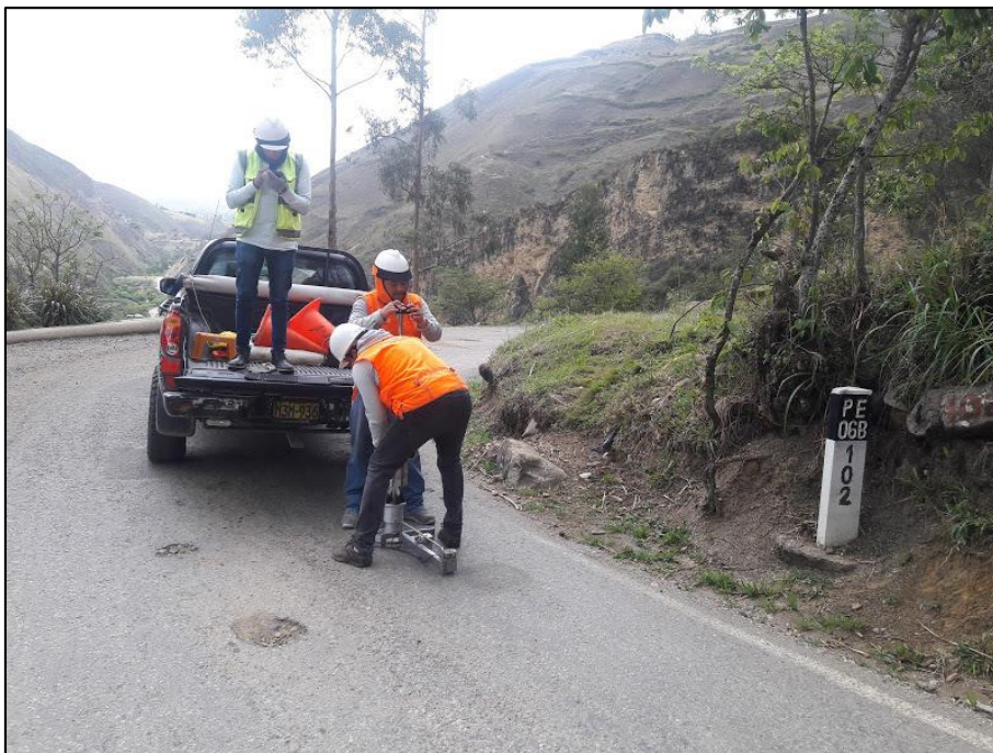
Figura 12 Trabajos de deflectometría Liviana en el tramo Puente Cumbil – Santa Cruz para Geoconsult Fuente: Elaboración propia
