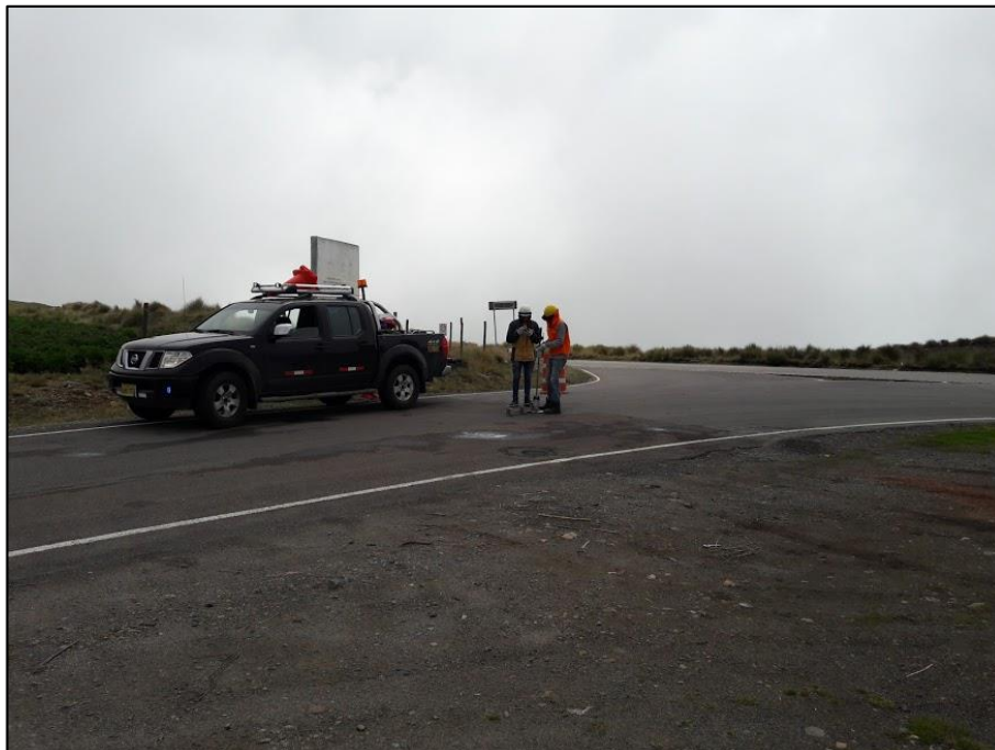
Figura 24 Trabajos de deflectometría Liviana en el tramo Ayacucho – Desvió Ocos para la empresa Geoconsult Ingenieros Fuente: Elaboración propia.
