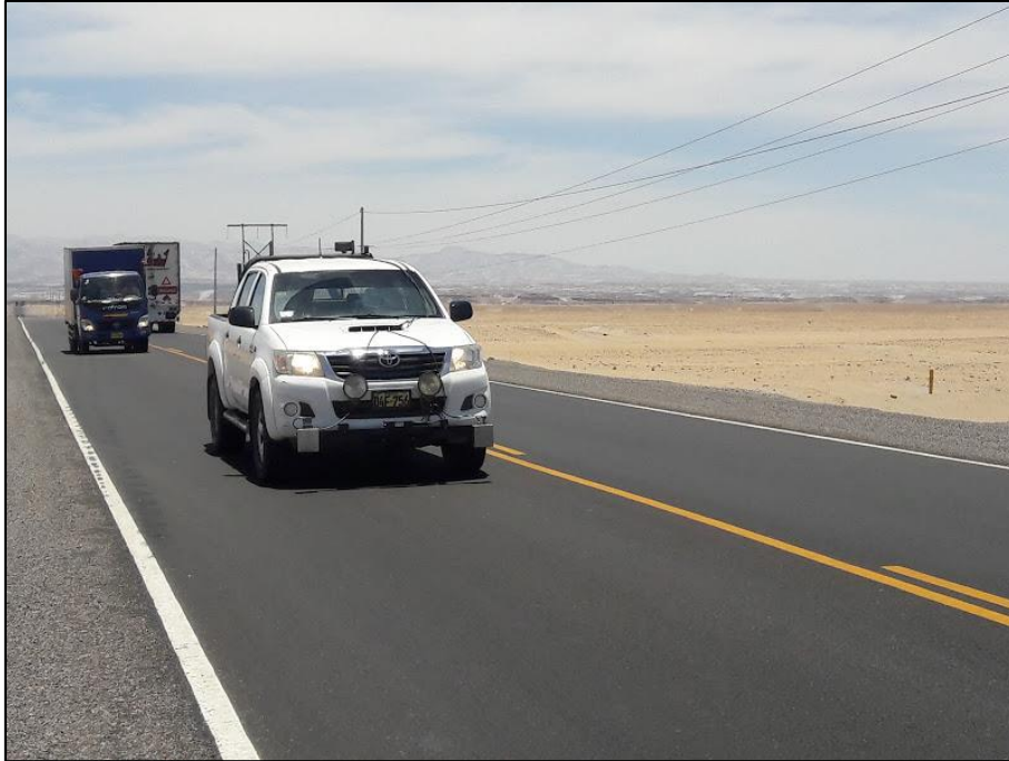
Figura 17 Trabajos de evaluación funcional (IRI) mediante el perfilómetro laser en el KM 877+00 al KM 902+000 de la ruta PE-1S para la Concesionaria Peruana de Vías Covinca S.A Fuente: Elaboración propia
