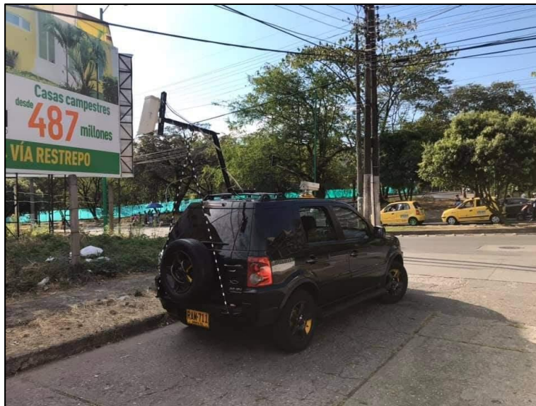
Figura 5 Método de auscultación de fallas por video. Propiedad de la empresa ITINERIS PERU S.A Fuente: Elaboración propia
