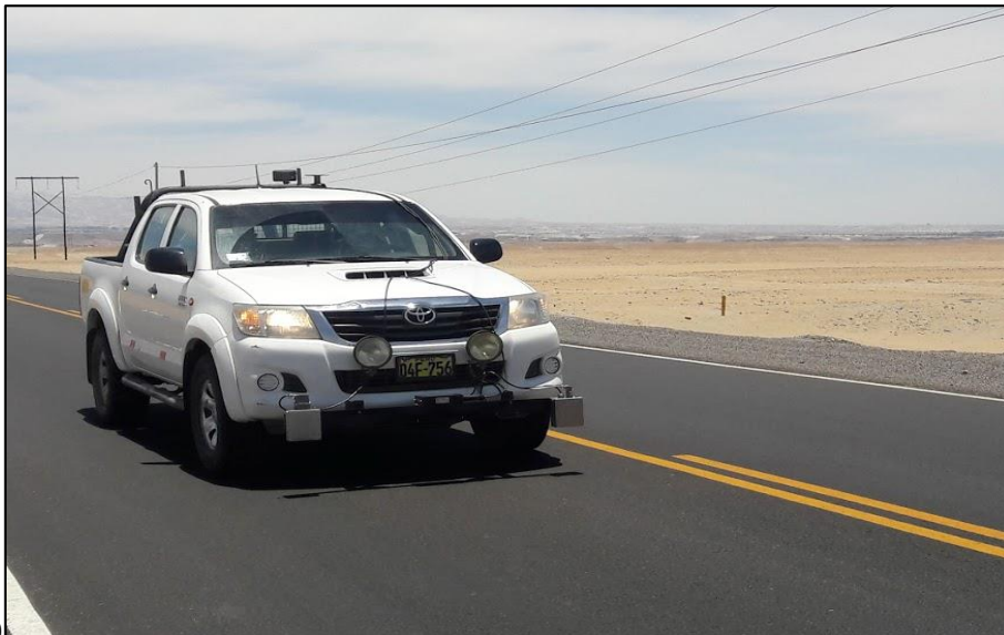
Figura 18 Trabajos de evaluación funcional (IRI) mediante el perfilómetro laser en el KM 877+00 al KM 902+000 de la ruta PE-1S para Covinca S.A Fuente: Elaboración propia
