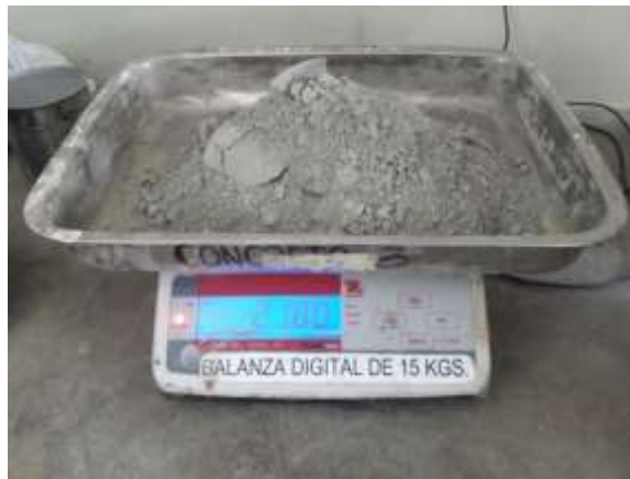
Foto 2: peso de cemento.
