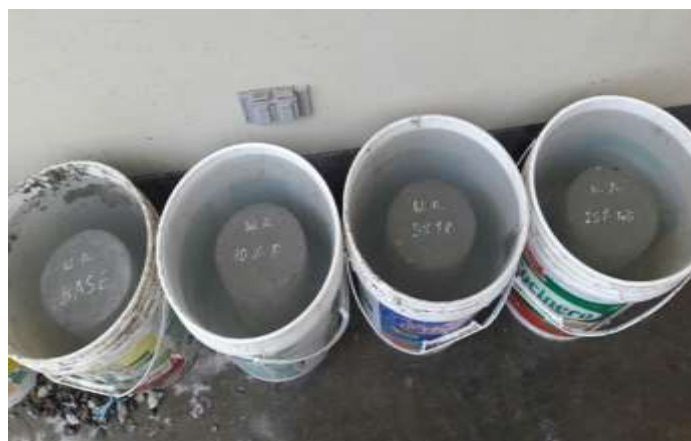
Figura 5: probetas sumergidas en agua para el curado.
