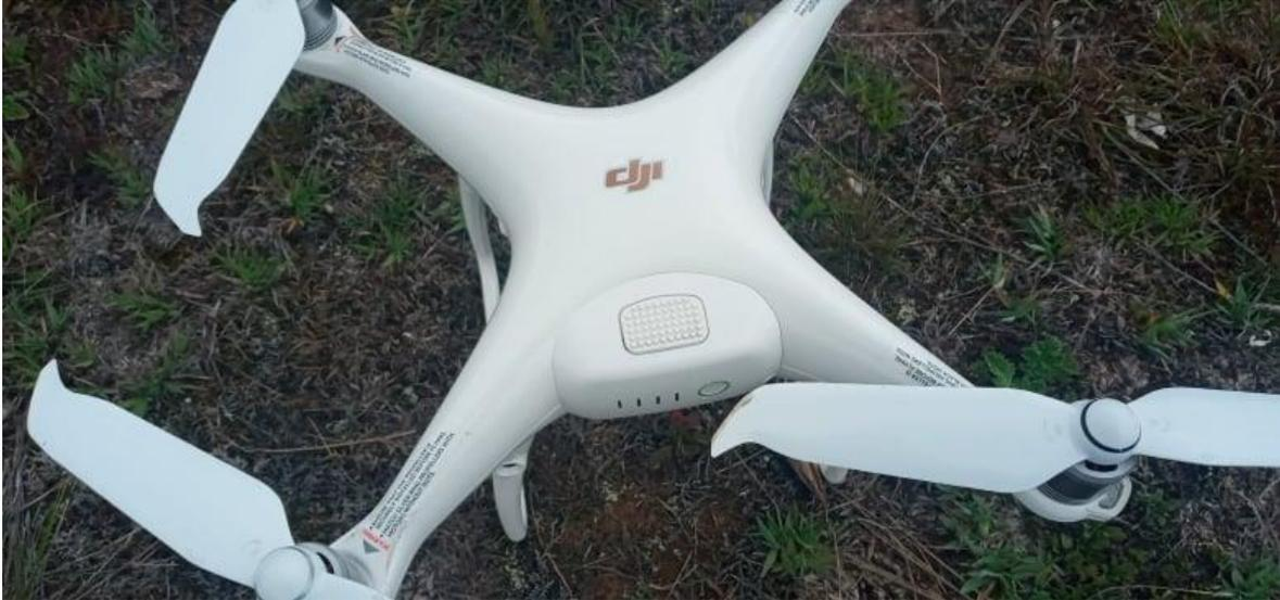
Dron DJI utilizado para el levantamiento topográfico
