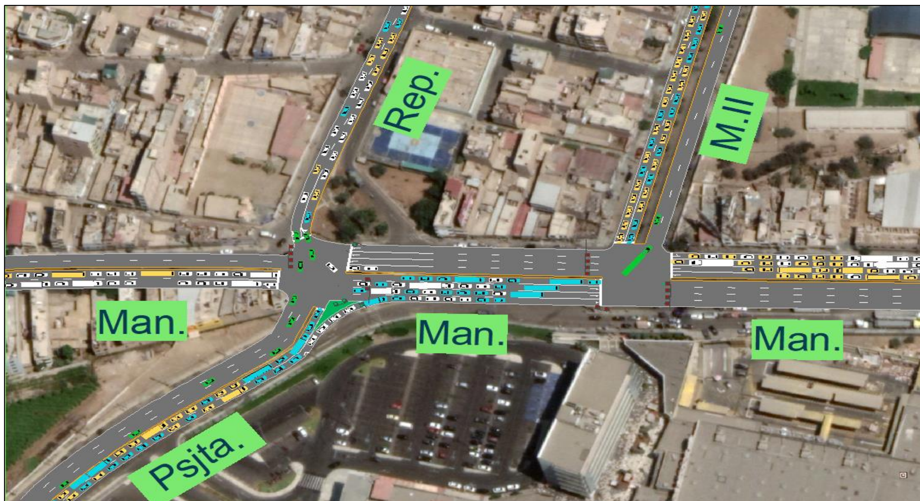
Figura 65. Microsimulación 2d de la situación actual para la intersección N°01 y N°02 empleando el software Sim Traffic 11
