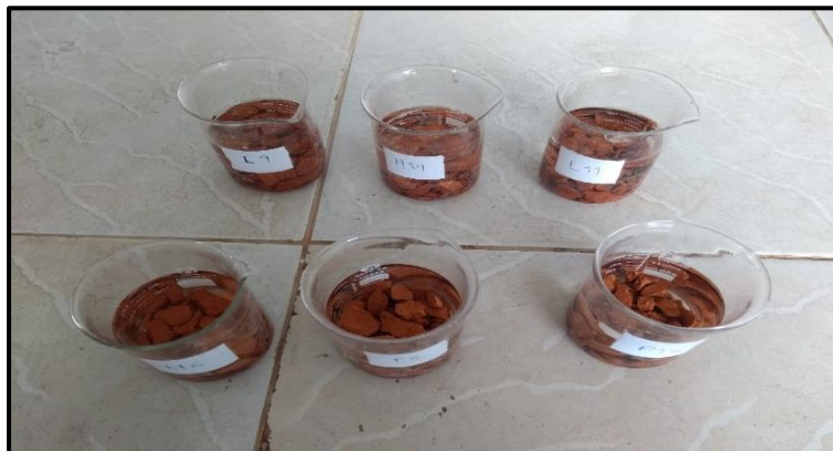
Figura 8.6. Vaso graduado con muestras de ladrillo para ensayo de pH y conductividad.
