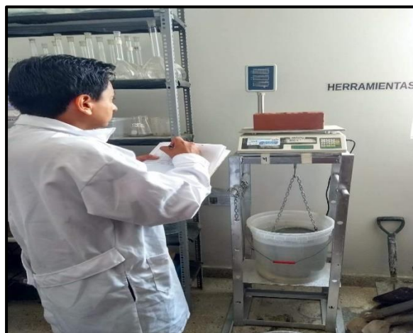
Figura 8.4. Peso saturado de la unidad de albañilería.
