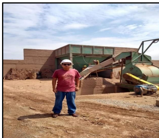
Figura 8.10. Tamizado de la ladrillera Huanchaco.
