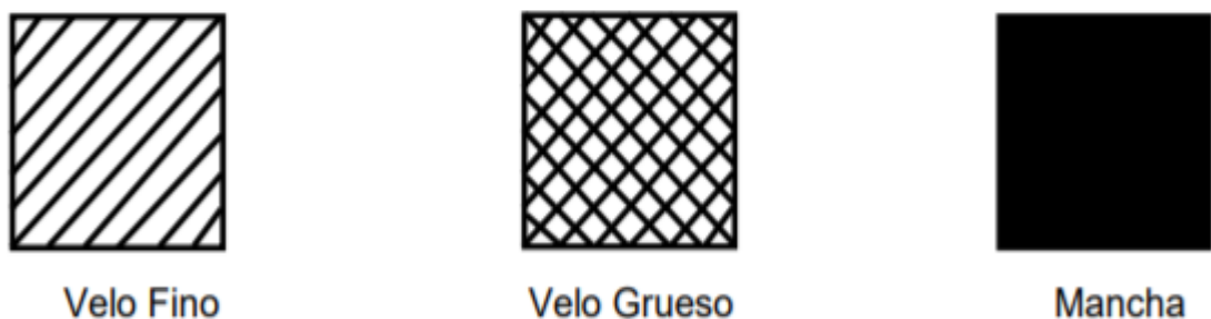
Figura 1.20. Intensidad de la eflorescencia, según su área afectada.
