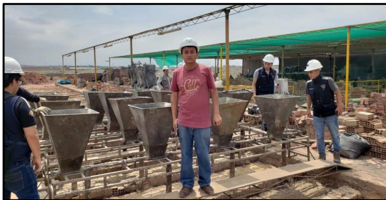
Figura 8.9. Cocción en ladrillera Huanchaco, quemadores con carbón y pajilla de arroz.
