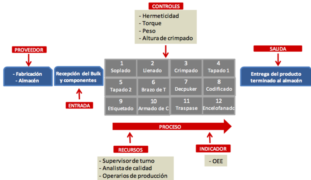
Figura 13 Proceso de envasado de Champú
