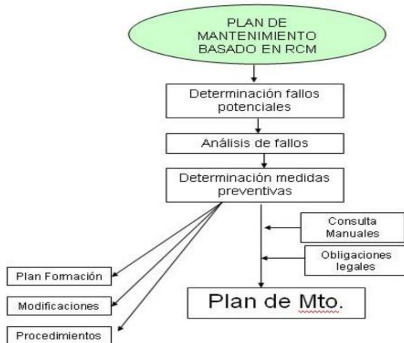
Fig. 9. Diagrama de flujo de la elaboración del plan de mantenimiento preventivo basado en el análisis de fallos RCM
