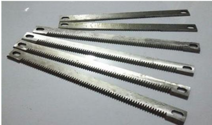
Fig. 26 Pieza principales, cuchillas horizontales Fuente: Fuxion Biotech SAC
