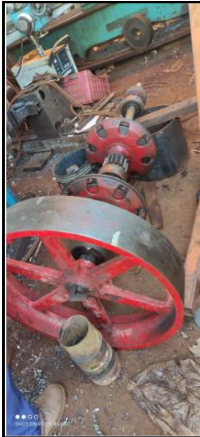
Volante y embriague de maquina percutora, con defectos en su funcionamiento (alineación incorrecta).
