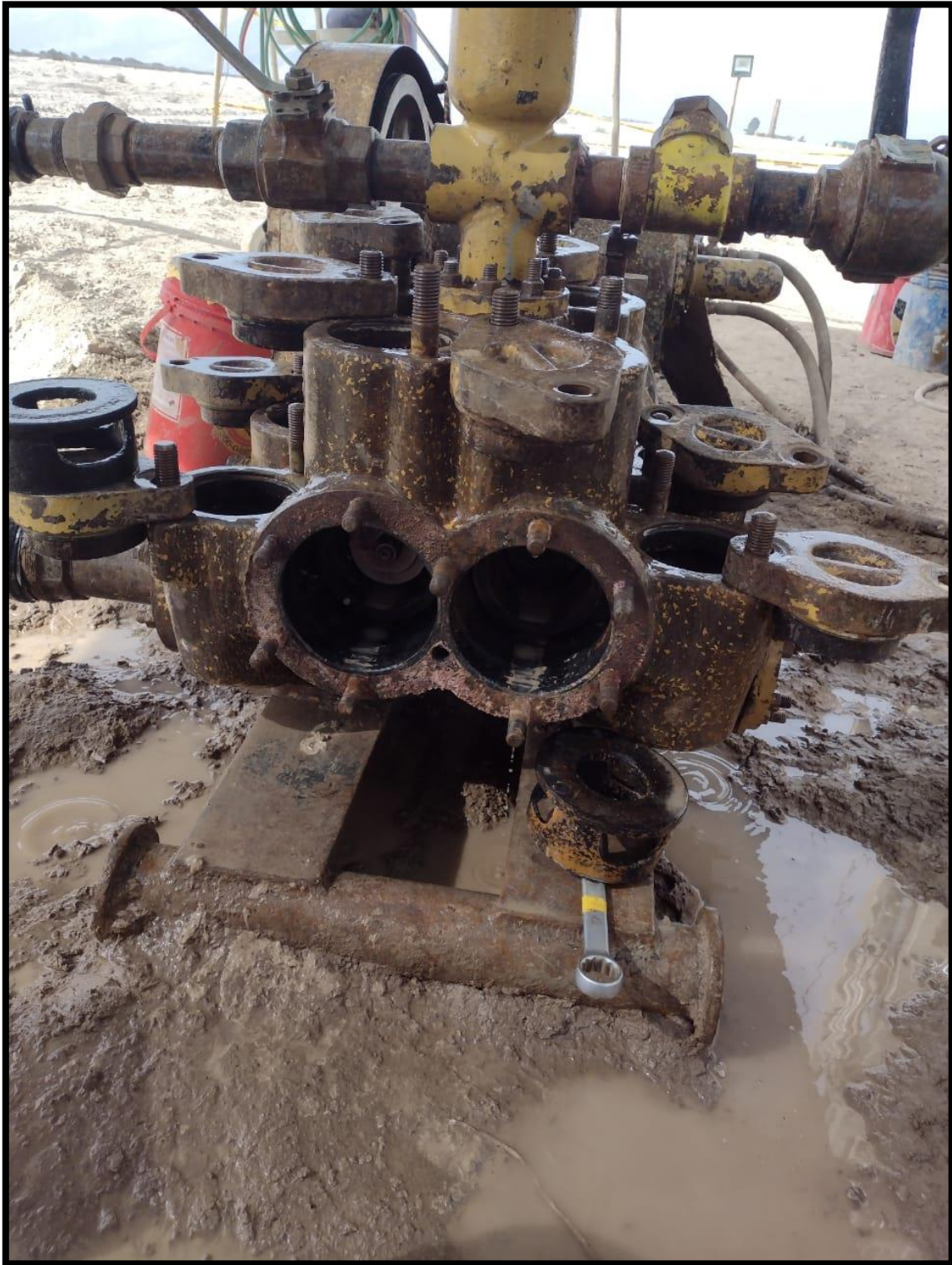
Mantenimiento general de la máquina de lodo.
