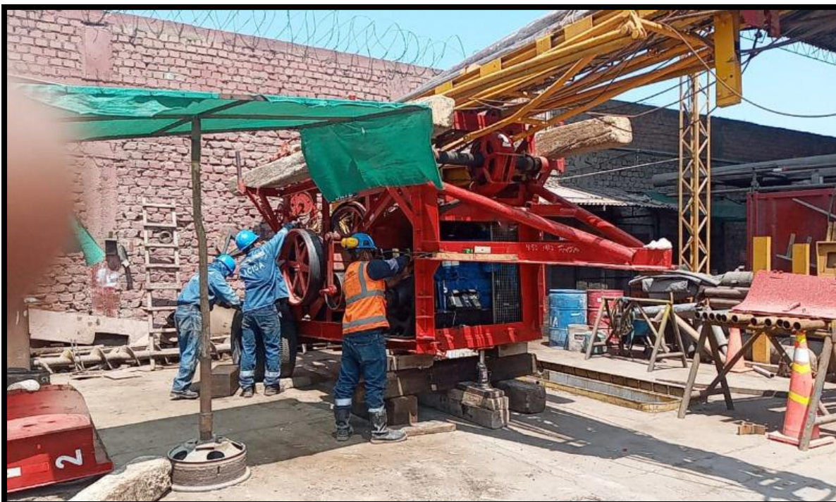
Personal realizando mantenimiento preventivo a la máquina percutora antes de salir a obra
