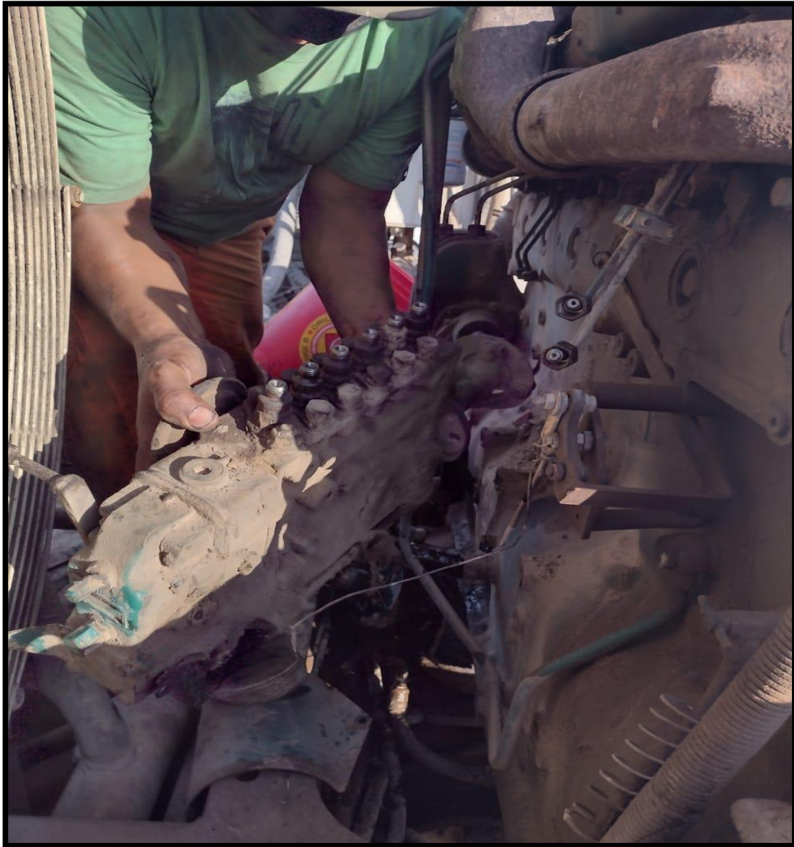
Personal realizando el mantenimiento según procedimientos de trabajo a la bomba de inyección.
