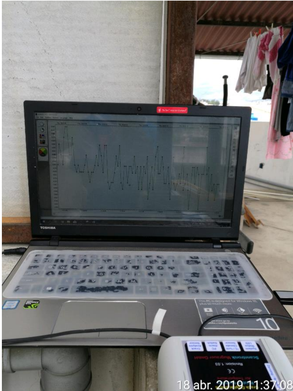
Fotografía 80: Lectura y comportamiento de fisura en software SoftFOX 3.03 en Azotea.
