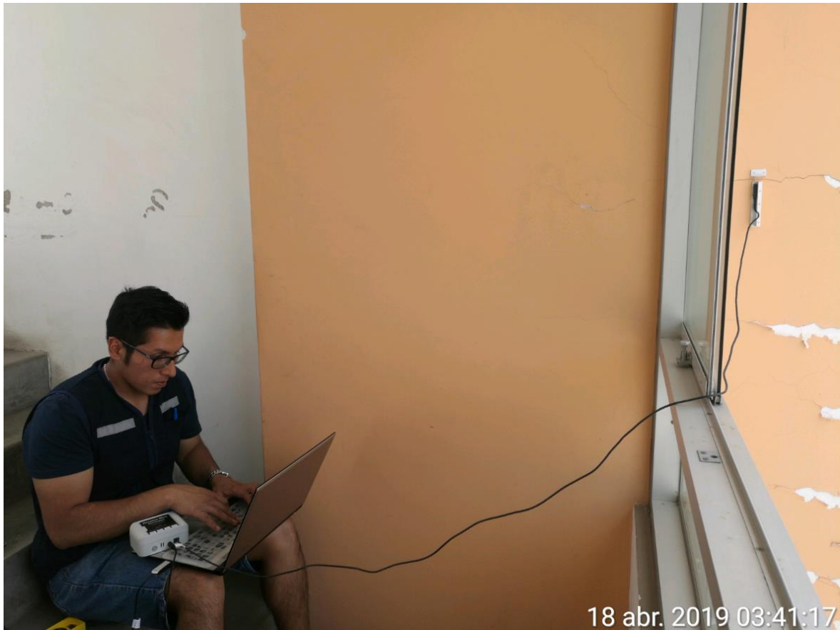
Fotografía 83: Toma de datos de fisura en software SoftFOX 3.03 en Azotea.
