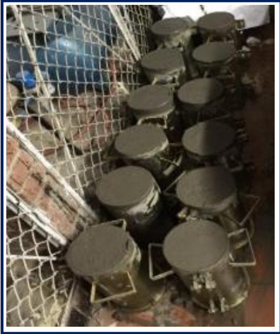
Figura 10. Encofrado de probetas de concreto
