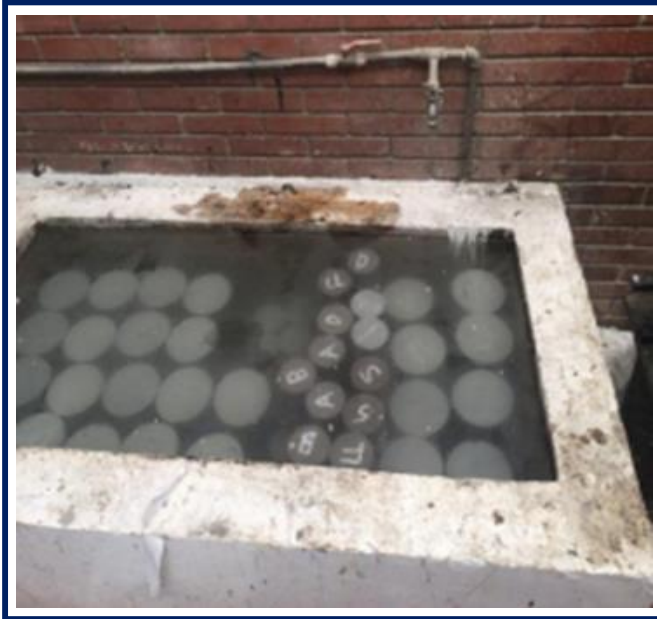
Figura 11. Curado de probetas de concreto
