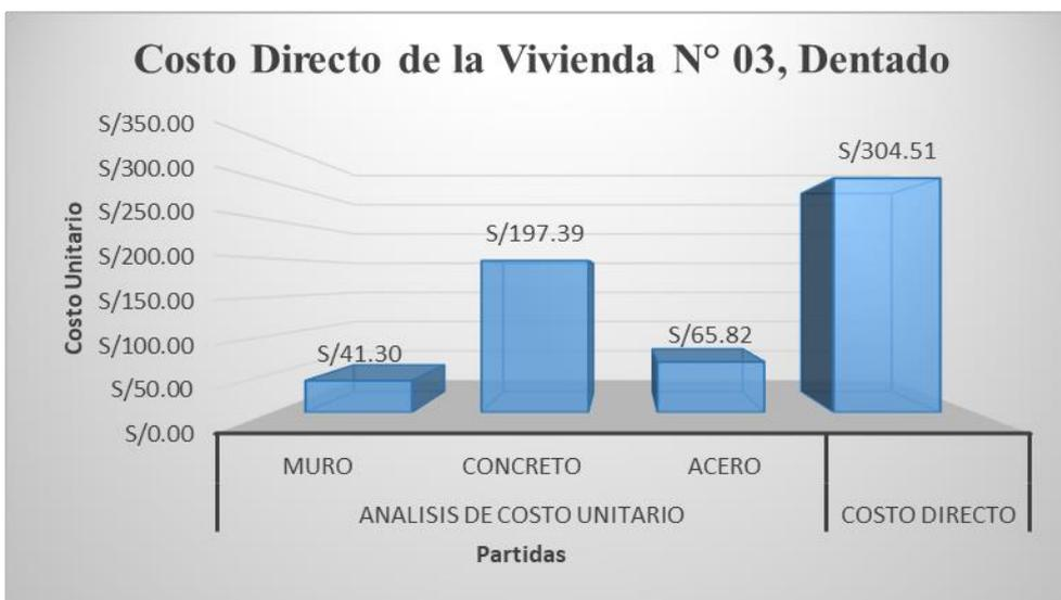
Figura 54: Costo Directo de la Vivienda N° 03 con el tipo de conexión Dentado.
