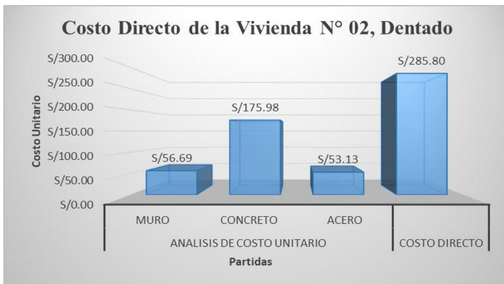
Figura 53: Costo Directo de la Vivienda N° 02 con el tipo de conexión Dentado.
