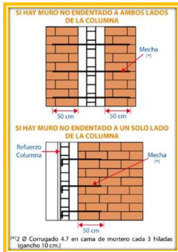
Figura 4: Muro representando el tipo de Conexión al Ras en interacción con el acero de la columna y la ubicación de mechas.
