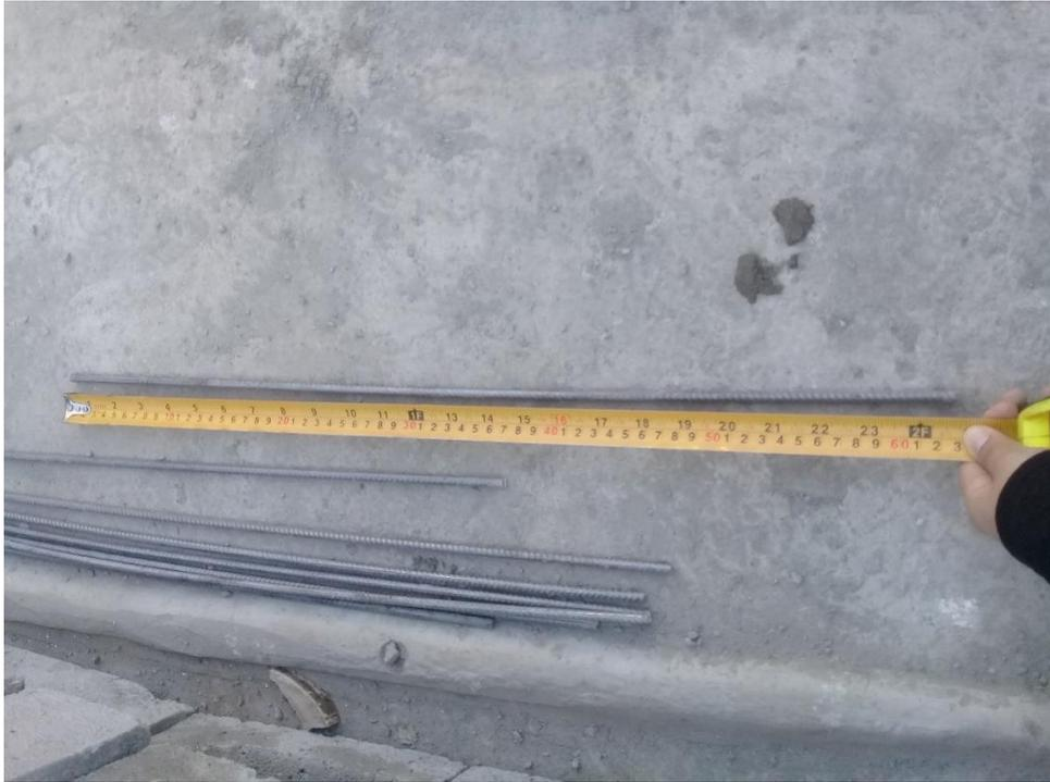
*Figura 89:* Midiendo con wincha las dimensiones de las mechas.
