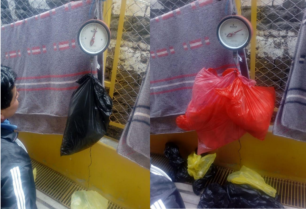
Figura 17 Pesado de bolsas en estudio de caracterización
