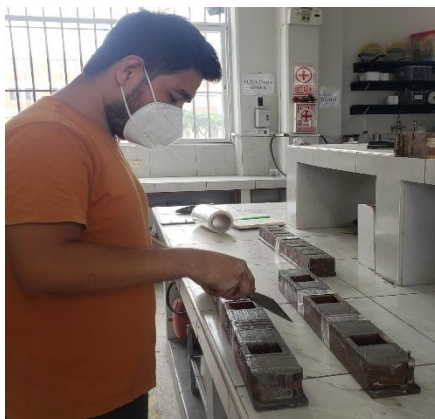
Figura 2.4. Conformado de probetas cúbicas de 5 cm x 5 cm x 5 cm
