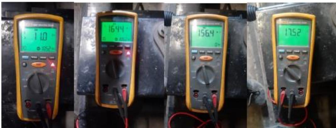
*Imagen 03: Mediciones de aislamiento del estator principal y estator excitatriz. En las imágenes se muestran las lecturas del aislamiento realizada según el plan de mantenimiento anual.*
