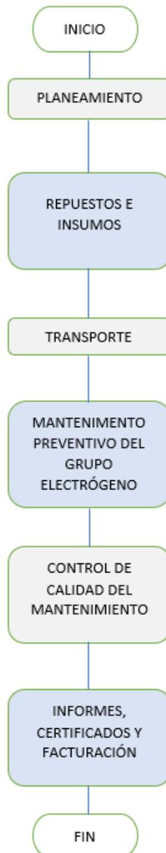
La Figura N° 1 indica los 17 pasos a seguir, se divide en 6 bloques para realizar el mantenimiento preventivo del grupo electrógeno, cuyo proceso de aplicación se cumple para el desarrollo de la presente investigación.
