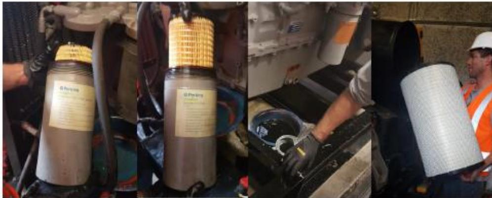
Imagen 01: Filtros de combustible, aceite, aire y drenaje de aceite usado.
