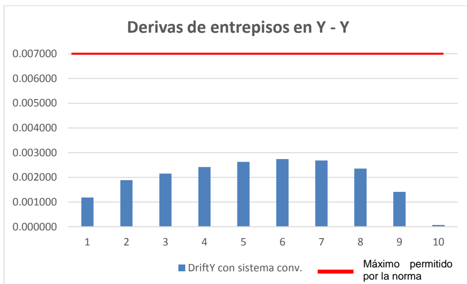
Figura 79. Resultados de distorsiones en la edificación máxima deriva 0.0101 según la normativa debe ser menor al 0.007.
