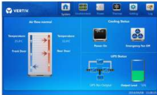
La pantalla LCD grande y táctil facilita el acceso a toda la información sobre potencia, gerenciamiento térmico, entorno, alarmas y configuración.
