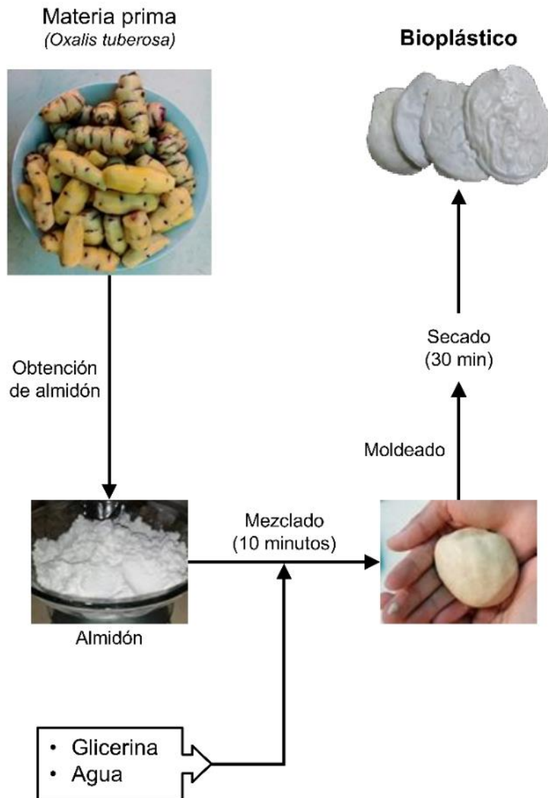
Figura 1. Esquema del proceso de elaboración de los bioplásticos a base de almidón de oca.
