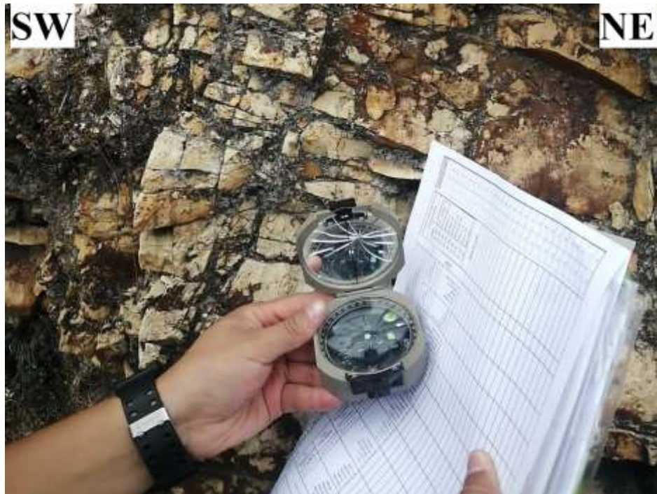
Figura 8. Obtenemos el valor de buzamiento con el uso de la brújula.
