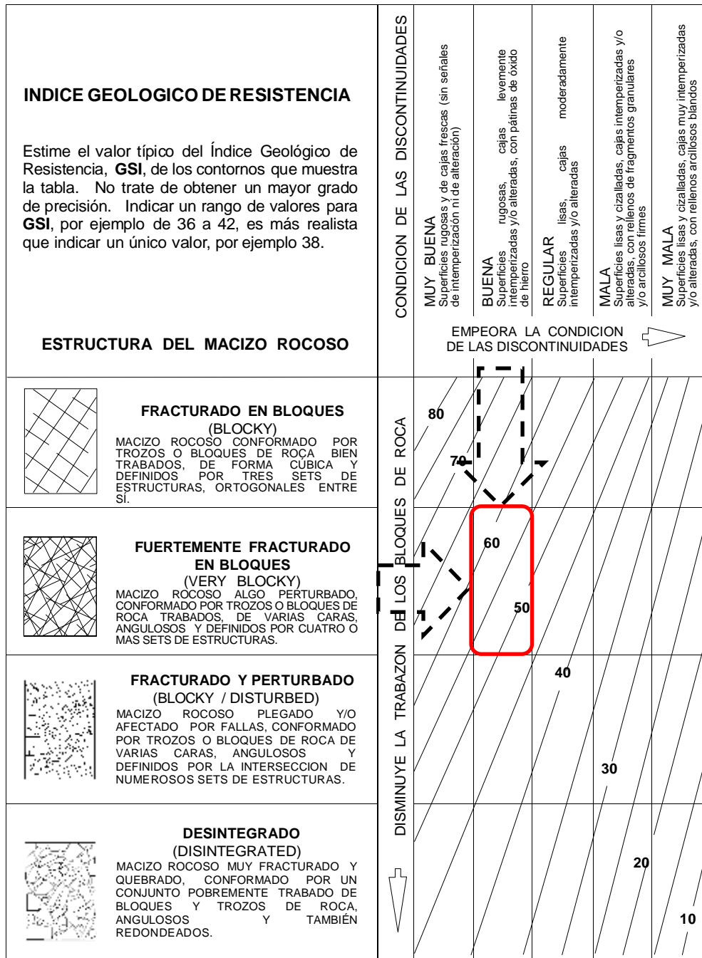
Figura 26. Para esta estación (N° 1) podemos observar que el GSI se encuentra comprendido entre los valores de 50-55. Fuente: Primer Taller Geotécnico Interdivisional.
