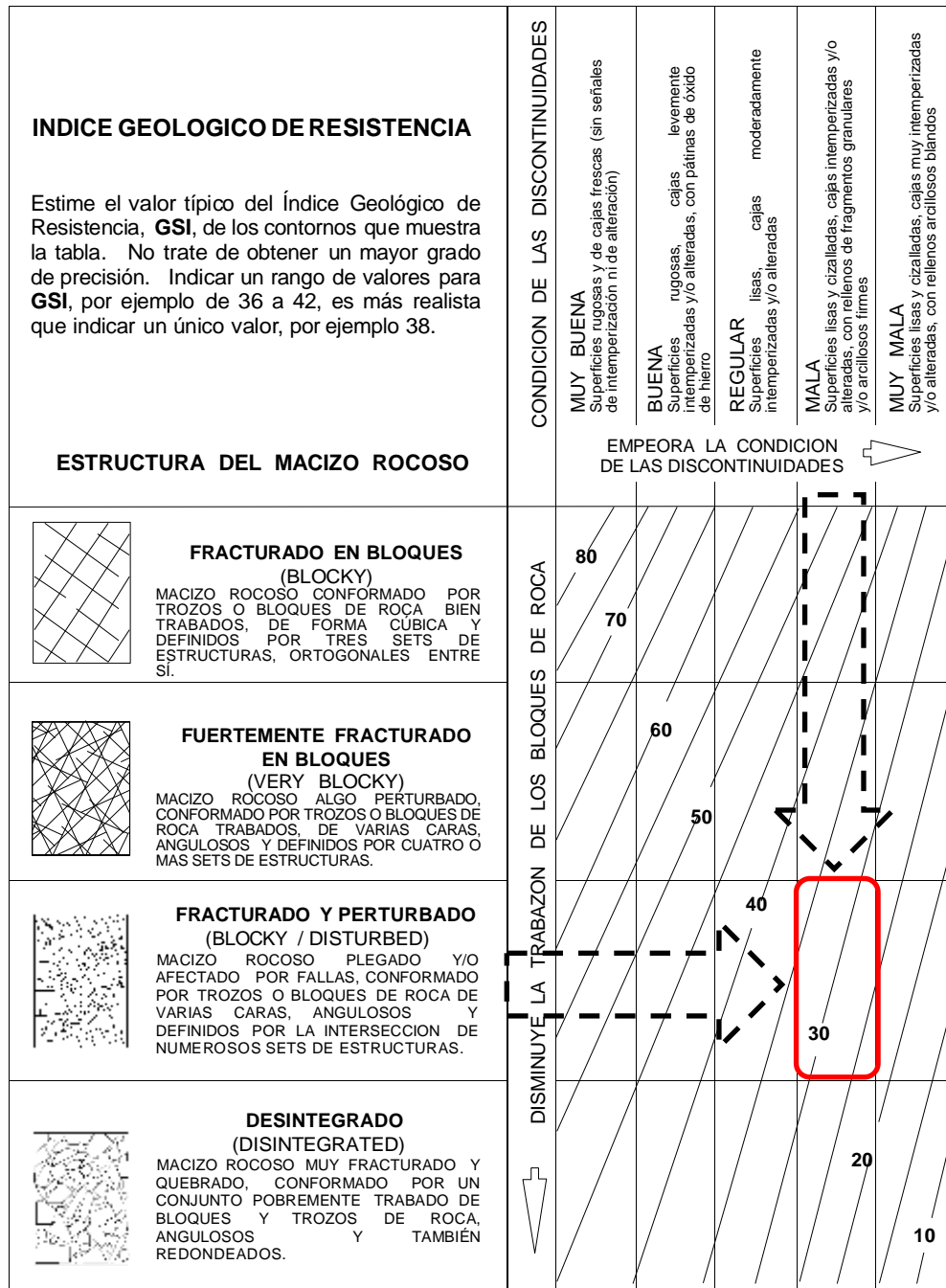
Figura 28. Para esta estación (N° 2) podemos observar que el GSI se encuentra comprendido entre los valores 30-35. Fuente: Primer Taller Geotécnico Interdivisinal.
