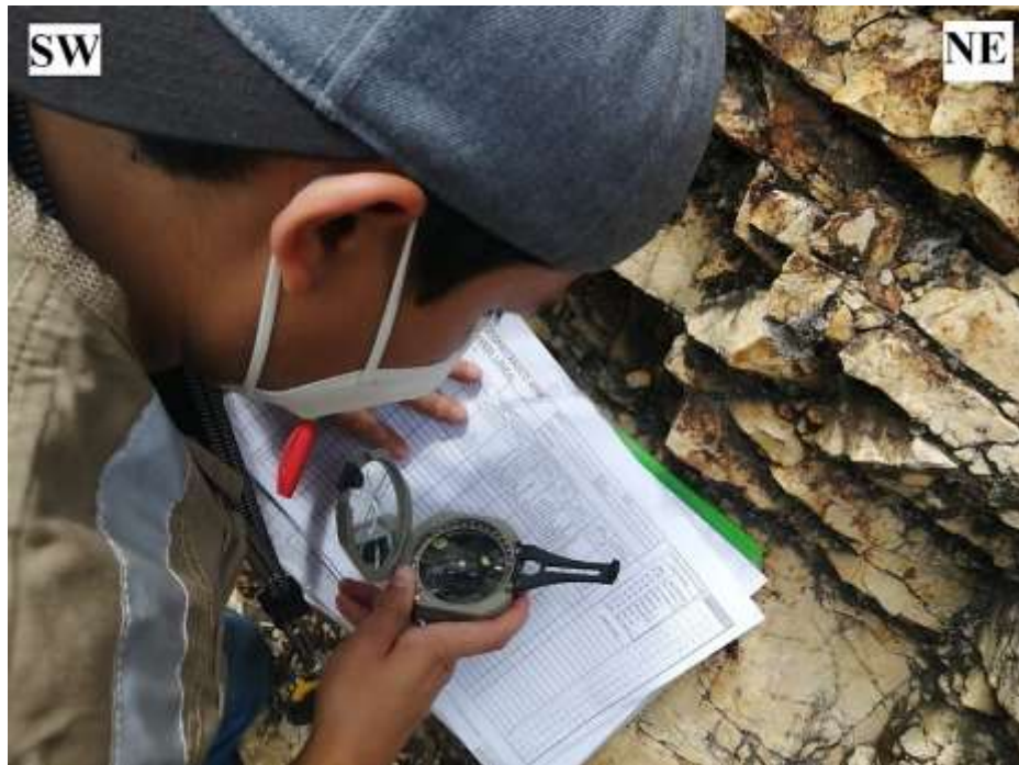
Figura 6. Usamos la brújula para tomar la dirección de inclinación y buzamiento.
