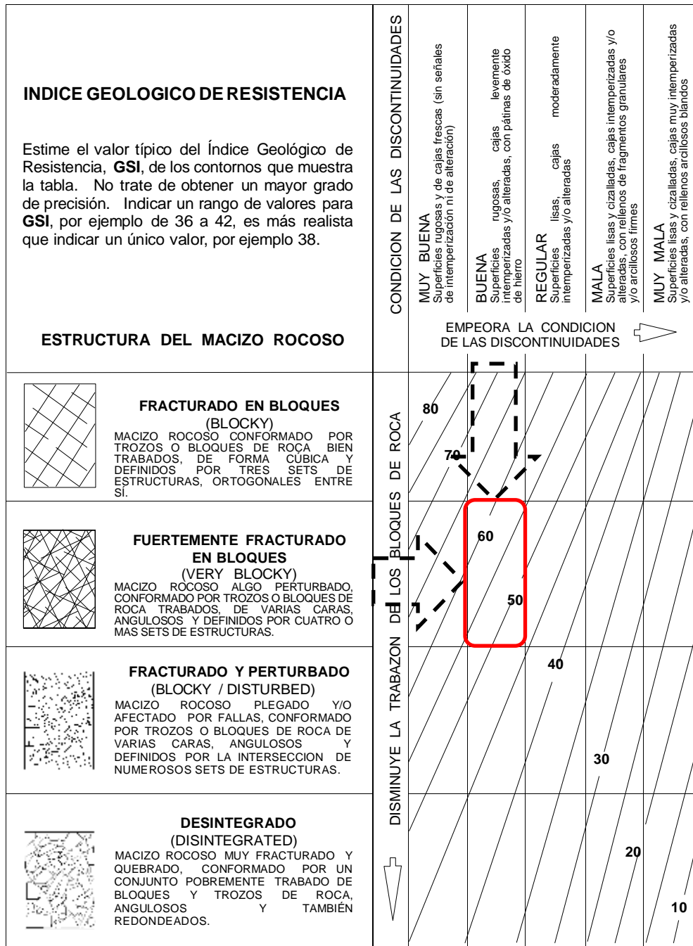
Figura 32. Para esta estación (N° 4) podemos observar que el GSI se encuentra comprendido entre los valores 45-50. Fuente: Primer Taller Geotécnico Interdivisional.
