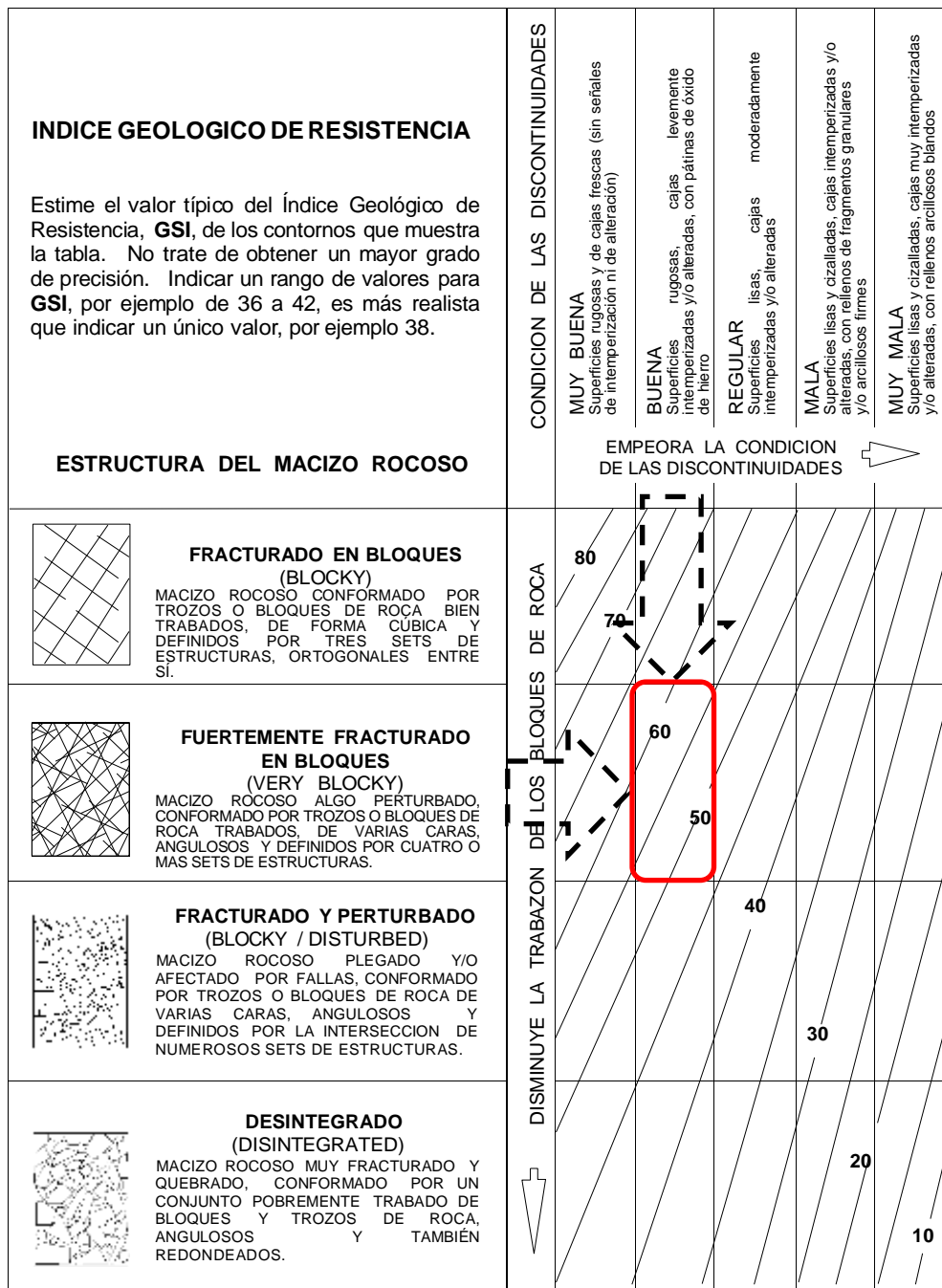
Figura 30. Para esta estación (N° 3) podemos observar que el GSI se encuentra comprendido entre los valores 55-60. Fuente: Primer Taller Geotécnico Interdivisional.
