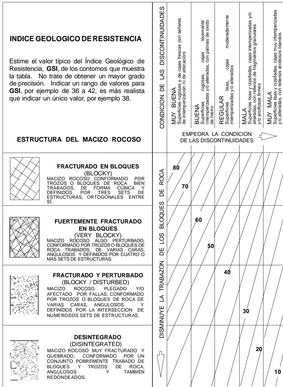
Figura 5. Gráfico para determinar el GSI que evalúa la calidad del macizo rocoso en función del grado y las características de la fracturación, estructura geológica, tamaño de los bloques y alteración de las discontinuidades. Fuente: (UPC, 2010).
