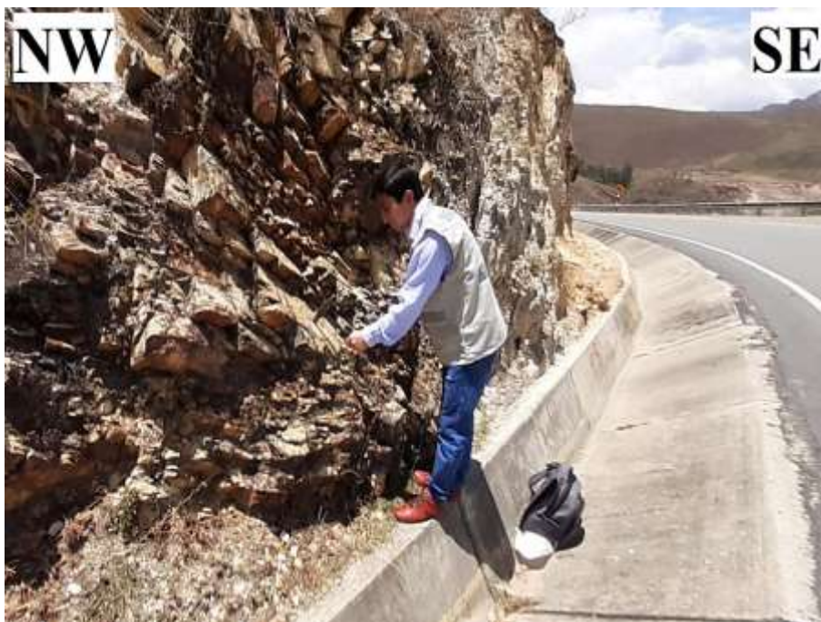
Figura 11. Con la picota obtenemos la resistencia a la compresión del macizo rocoso.
