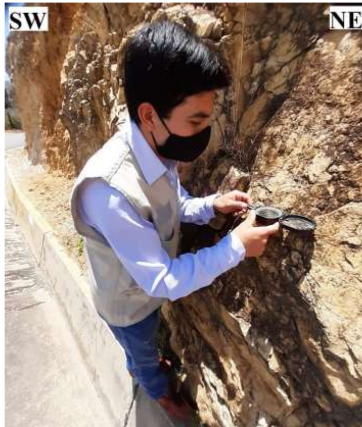
Figura 7. Usamos la brújula para obtener la dirección de inclinación en cada una de las estaciones.
