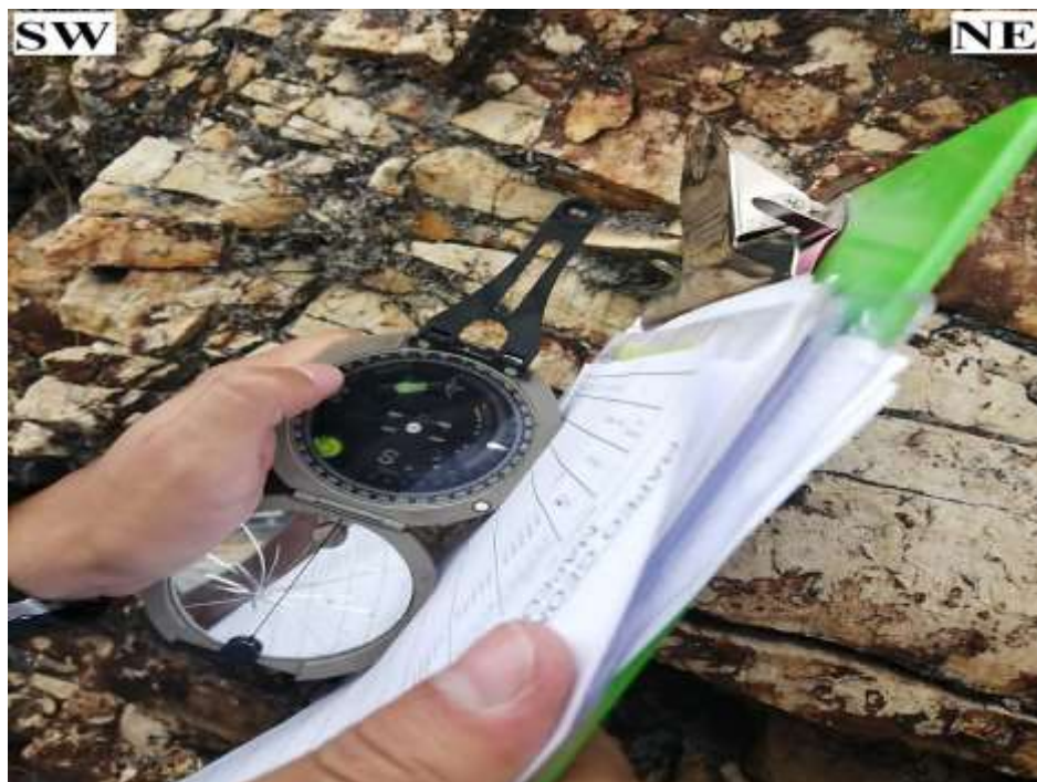
Figura 9. Cálculo del buzamiento de cada familia con el uso de la brújula.
