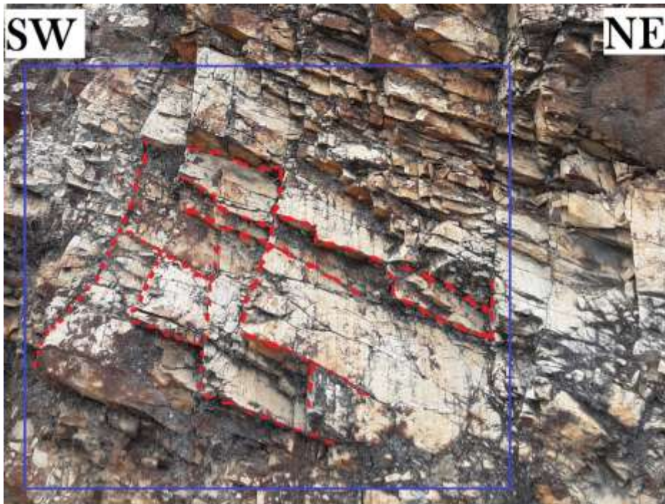
Figura 12. Conteo del número total discontinuidades por unidad de volumen ( 1\text{m}^3 ) del macizo rocoso.
