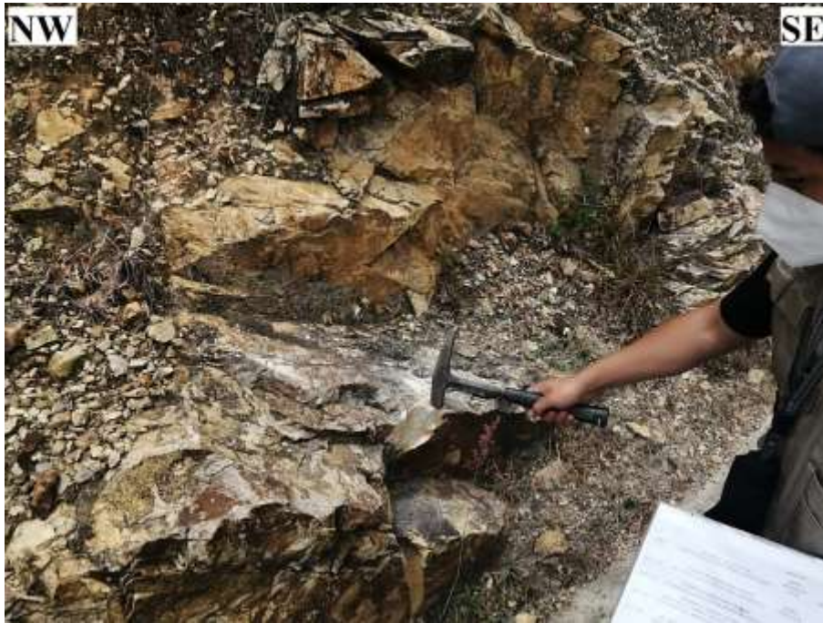
Figura 10. Uso de la picota de geólogo para calcular la resistencia a la compresión de las rocas.
