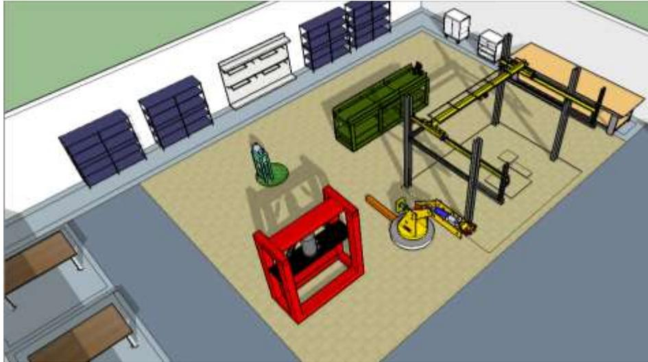
Figura 30. Área de reparaciones de cilindros
