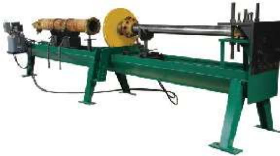
Figura 23. Banco de Reparación de Cilindros
