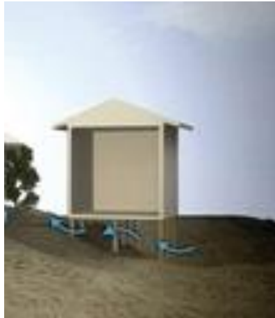
Figura N° 10: Uso de pisos ventilados
