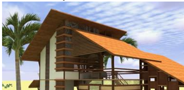
Figura N° 09: Uso de elementos de protección solar
