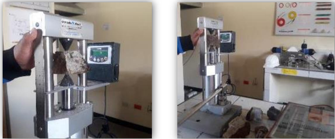
Figura 8. Ensayos de resistencia a la compresión simple en el laboratorio
