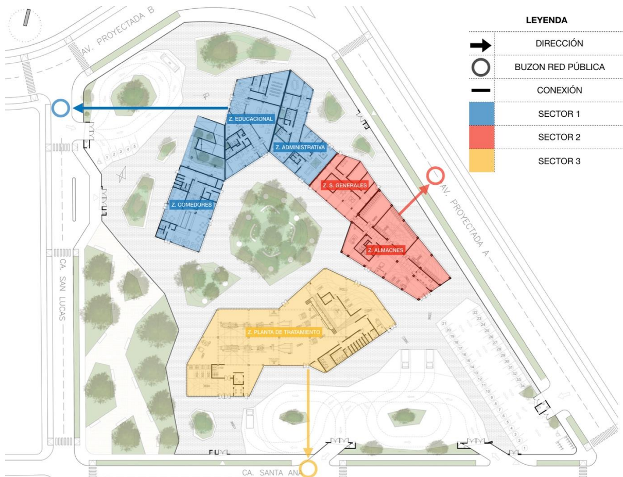
Figura 108 Distribución de la red de alcantarillado.
