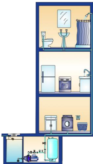
Figura 104 Esquema Gráfico del sistema hidroneumático.
