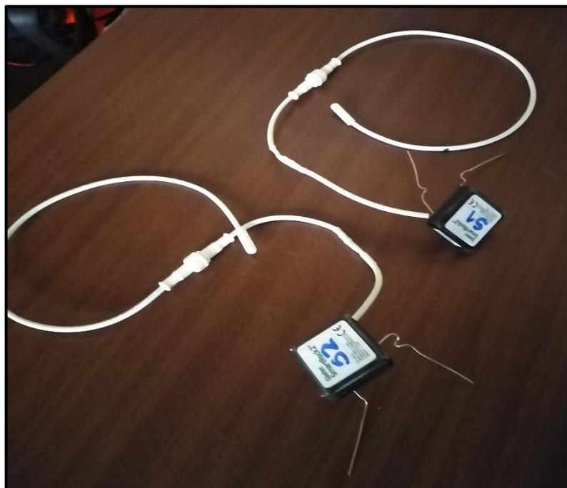
**Figura 32:** La figura muestra los sensores Smart Rock usados en el Método de Madurez. Autoría Propia.
