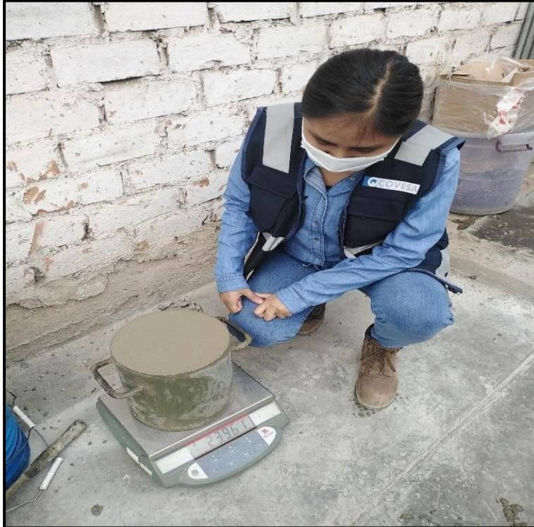
**Figura 29:** La figura muestra a la Bach. Rita Zavaleta realizando el Ensayo del peso unitario del concreto en estado fresco (ASMT C138 y NTP 339.046). Autoría Propia.
