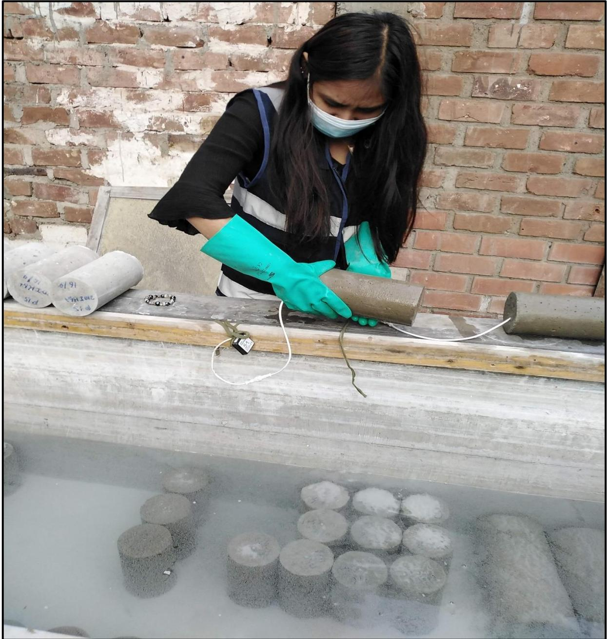
**Figura 39:** La figura muestra el curado durante 9 días de las probetas para ambas mezclas de concreto. Autoría Propia.
