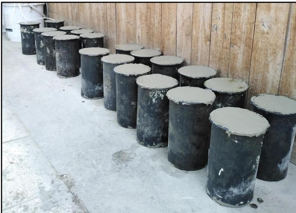
**Figura 38:** La figura muestra la realización de las 20 probetas cilíndricas de concreto elaborado con cemento tipo ICO. Autoría Propia.
