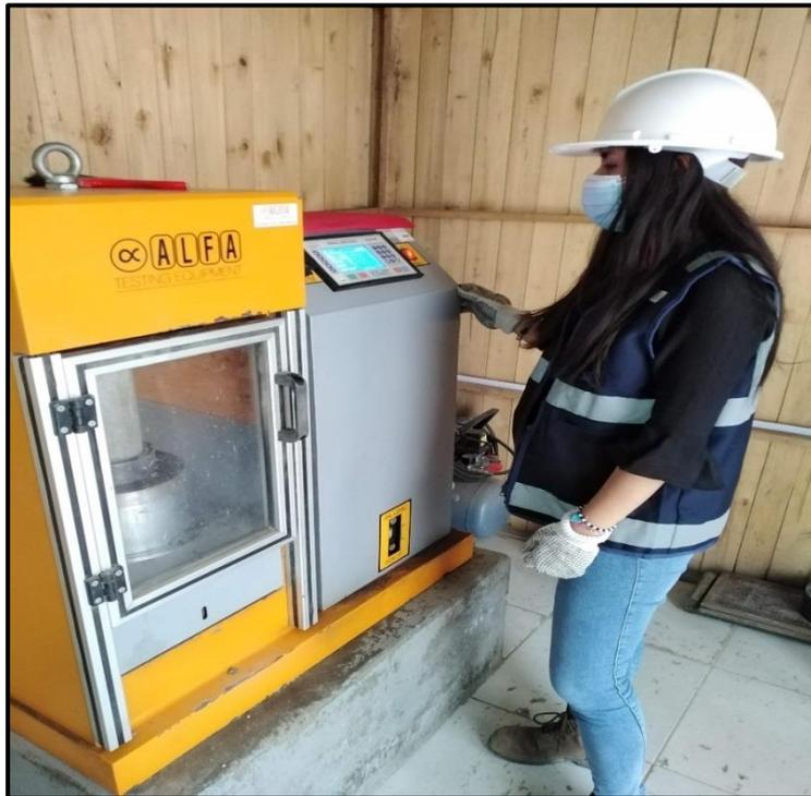
*Figura 35:* La figura muestra la rotura de probetas en la prensa.
