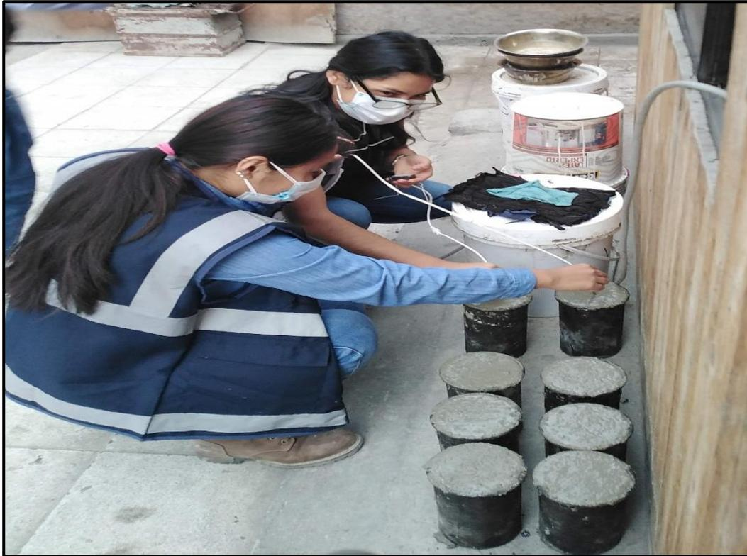
**Figura 33:** La figura muestra la colocación de los sensores a 2 probetas cilíndricas para cada diseño de mezcla de concreto. Autoría Propia.
