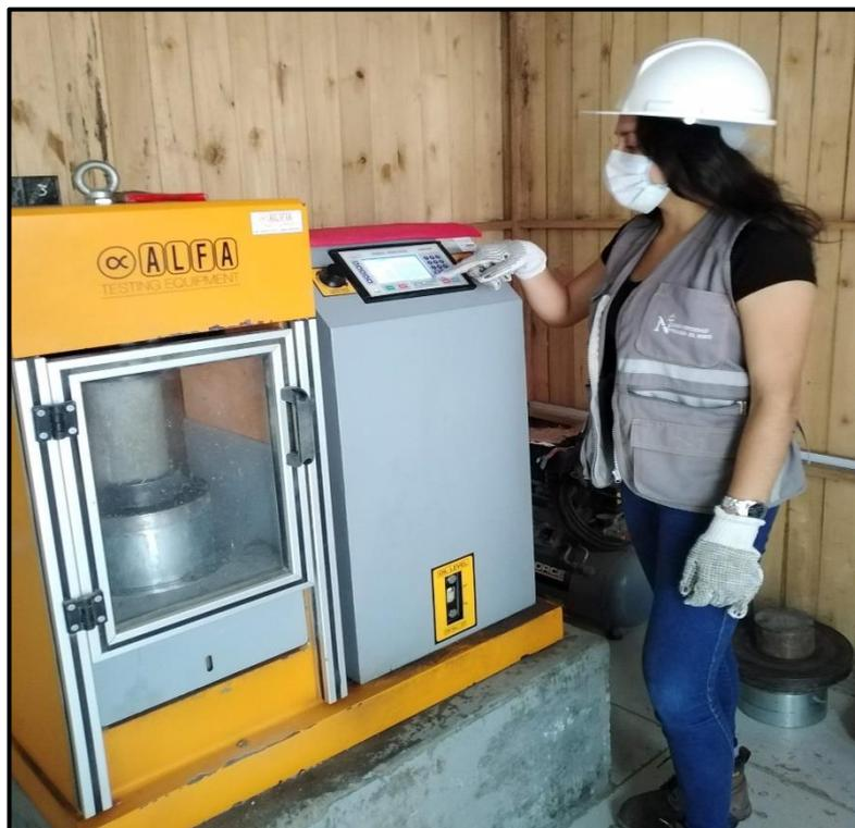
*Figura 36:* La figura muestra la rotura de probetas en la prensa para la extracción y recuperación de los sensores. Autoría Propia.
