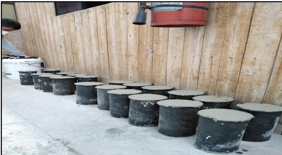
**Figura 34:** La figura muestra las 20 probetas cilíndricas de la mezcla de concreto elaborado con cemento tipo MS. Autoría Propia.
