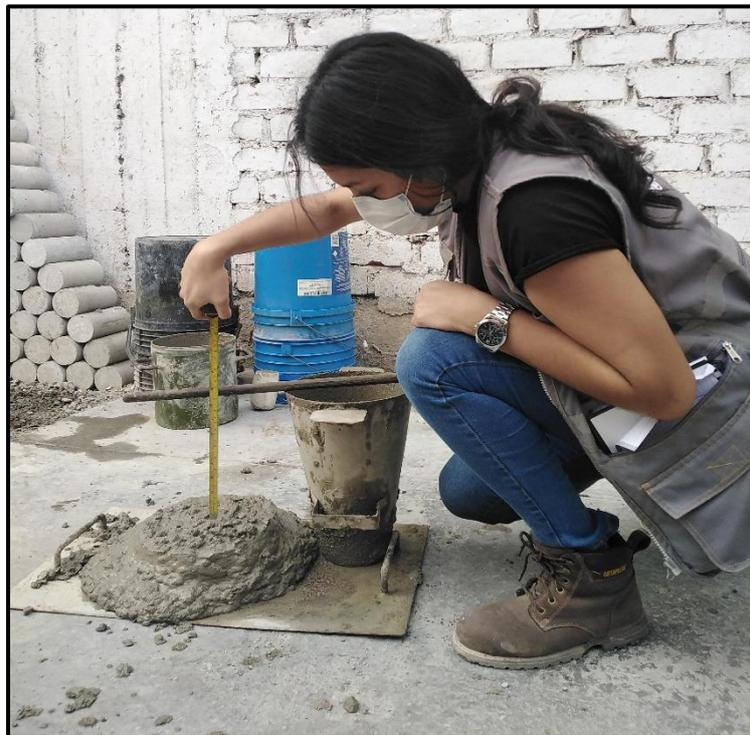
**Figura 30:** La figura muestra a la Bach. Evelyn Adrianzén realizando el Ensayo para la medición del asentamiento del concreto con el cono de Abrams (ASTM C143, NTP 339. 035). Autoría Propia.
