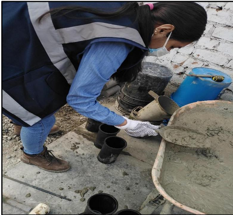
**Figura 37:** La figura muestra la elaboración de la mezcla de concreto elaborado con cemento tipo ICO. Autoría Propia.
