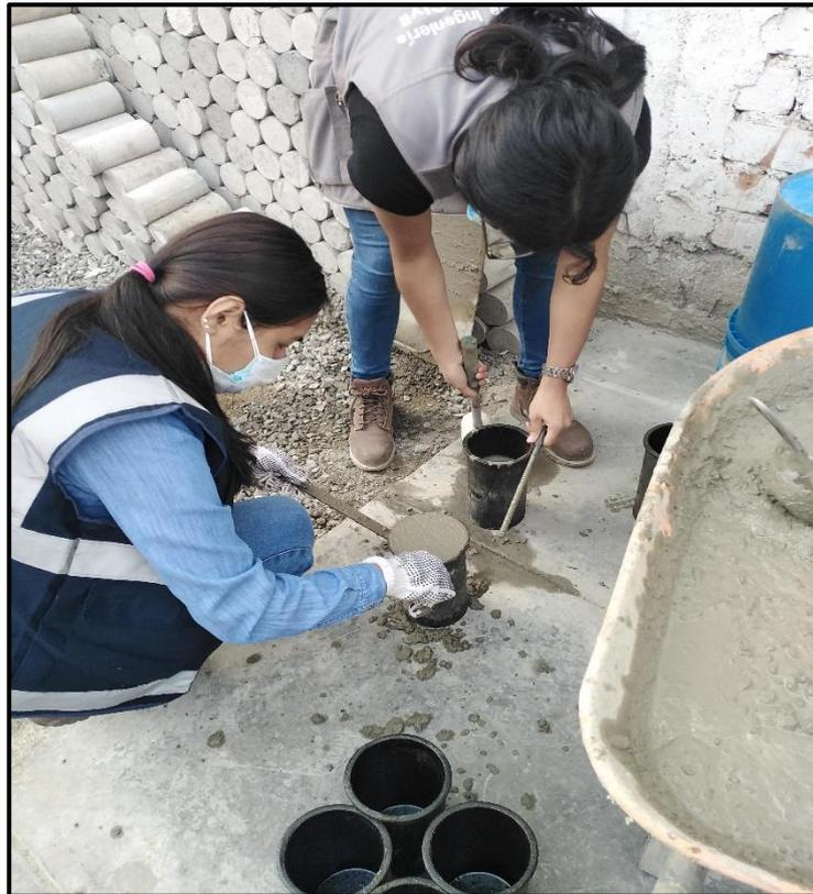
**Figura 31:** La figura muestra la elaboración de probetas cilíndricas de concreto. Autoría Propia.
