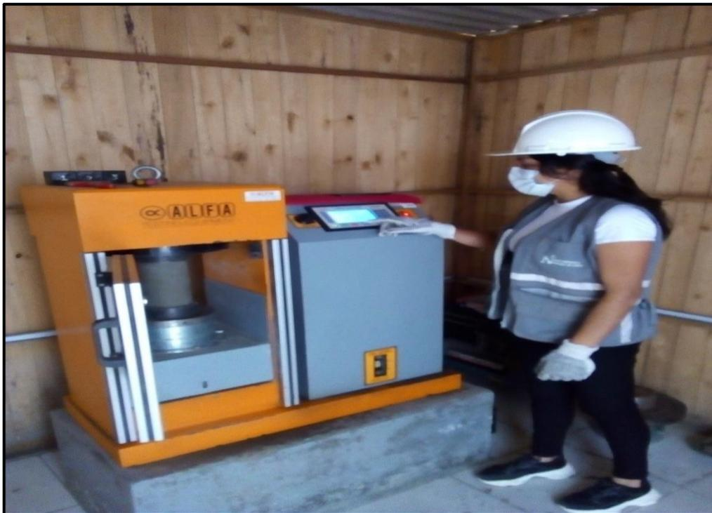
**Figura 9:** La foto muestra el ensayo de compresión en la prensa, teniendo en cuenta la norma NTP 339.217. Autoría Propia.
