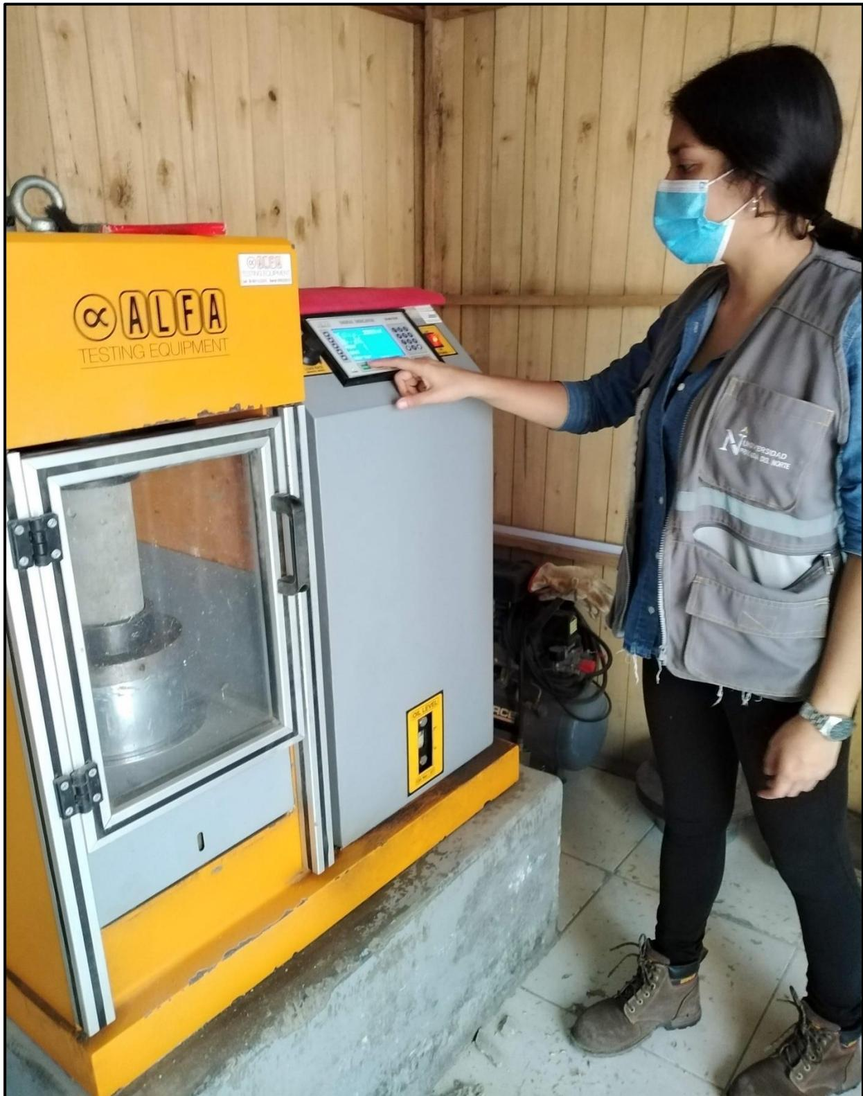
**Figura 40:** La figura muestra la rotura de probetas en la prensa para la mezcla de concreto elaborado con cemento tipo ICO. Autoría Propia.
