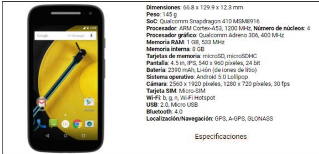
Figura N°12: Características del equipo móvil utilizado para el proyecto
