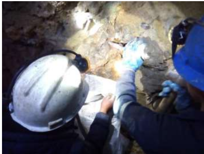
Recuperando el mineral de la segunda voladura, aplicando el método de Circado
