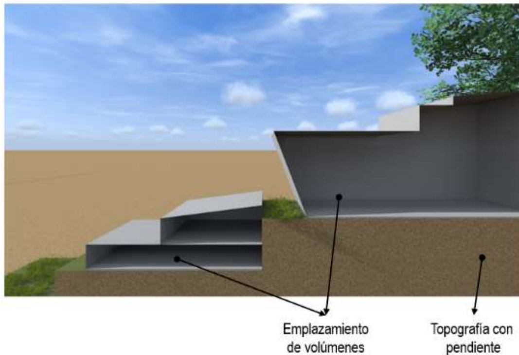
Figura 8. Representación de aplicación de volúmenes y plataformas euclidianas como adaptación a la topografía del terreno. Elaboración propia.
