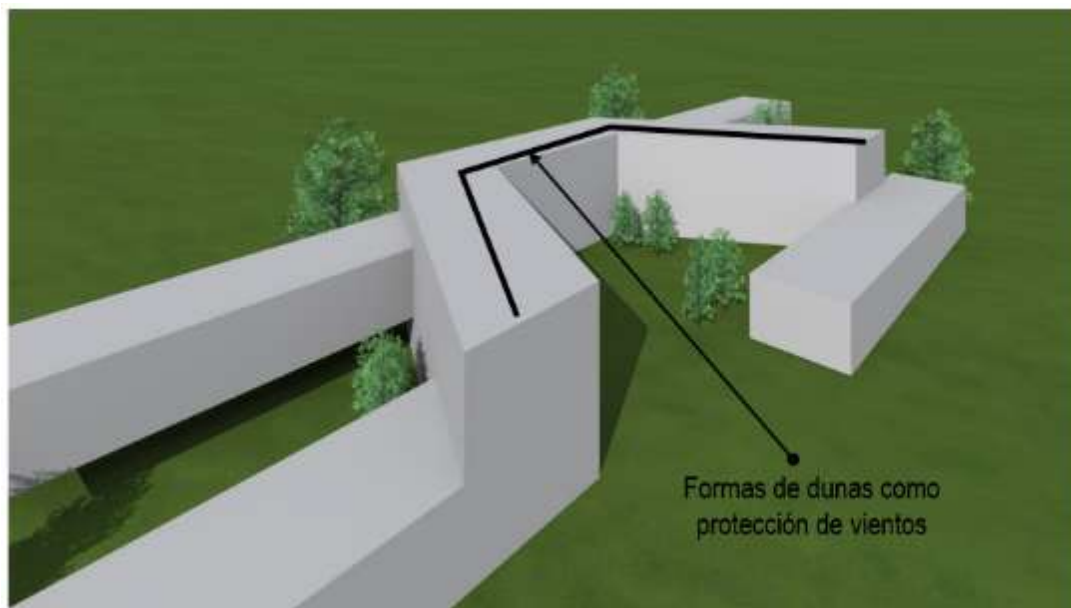
Figura 9. Representación de posicionamiento de volúmenes dirigidos de noreste a suroeste como generador de sombras y ventilación cruzada. Elaboración propia.
