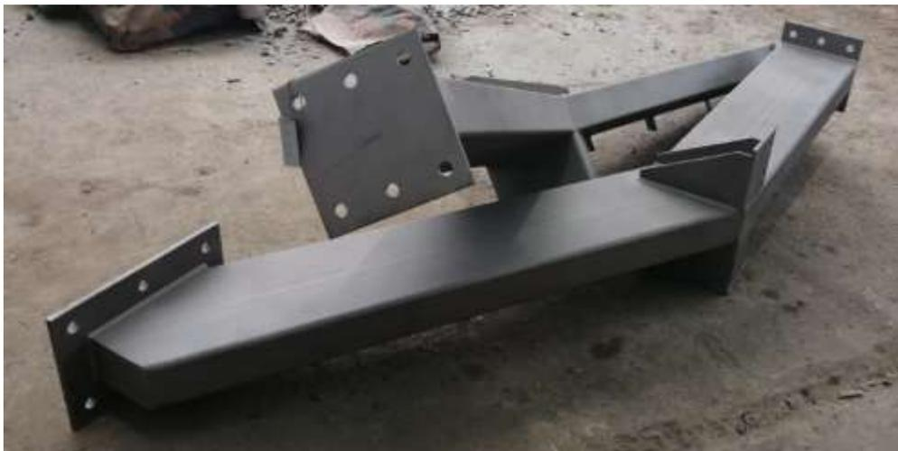
*Figura 40.* Granallado de pieza metálica
