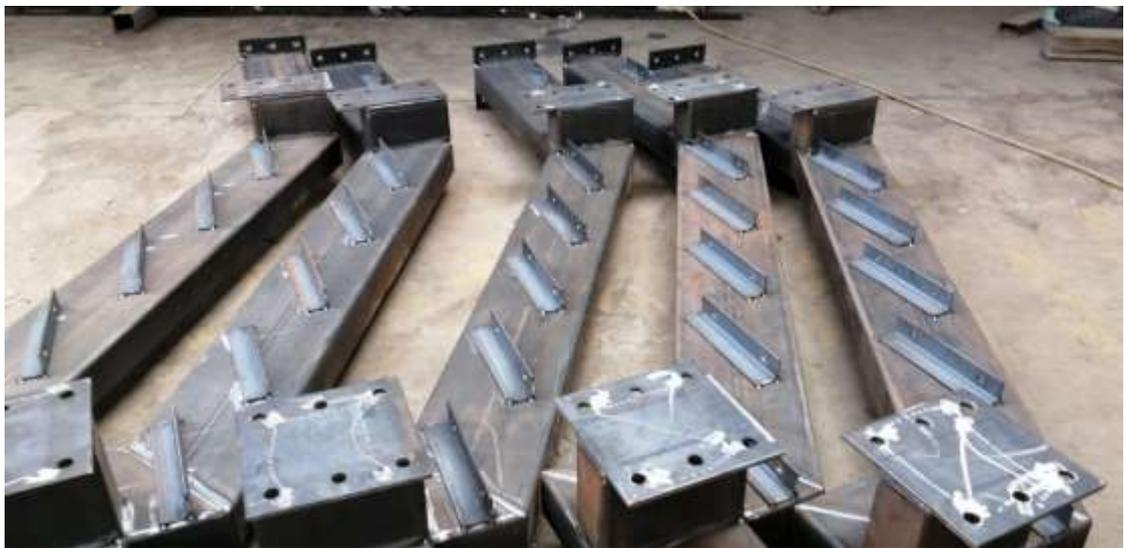
*Figura 32.* Armado de Banda de escalera metálica
