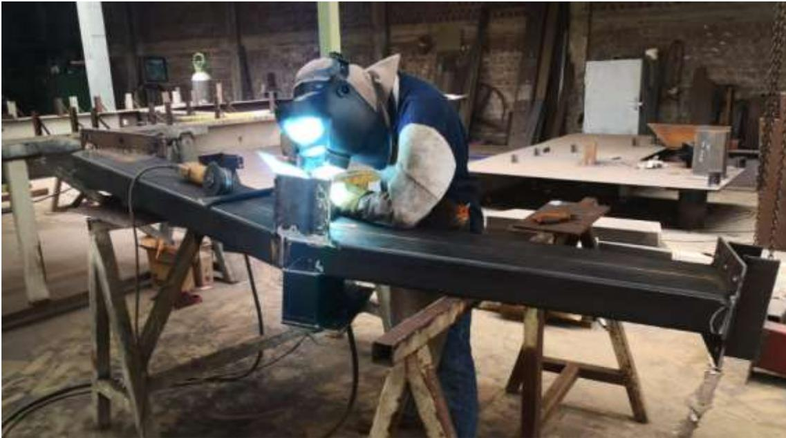
*Figura 37.* Soldeo de capa de acabado
