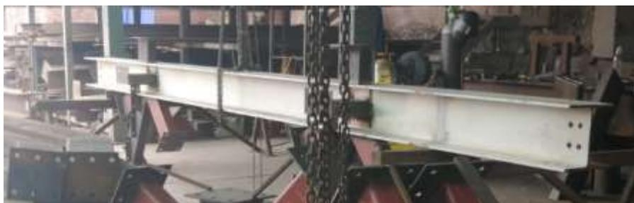
*Figura 30.* Armado de Columna metálica
