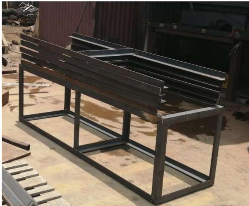
*Figura 51.* Habilitado y soldeo de módulo de torre grúa.
