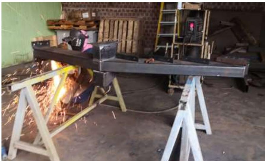
*Figura 36.* Limpieza entre capa de soldadura
