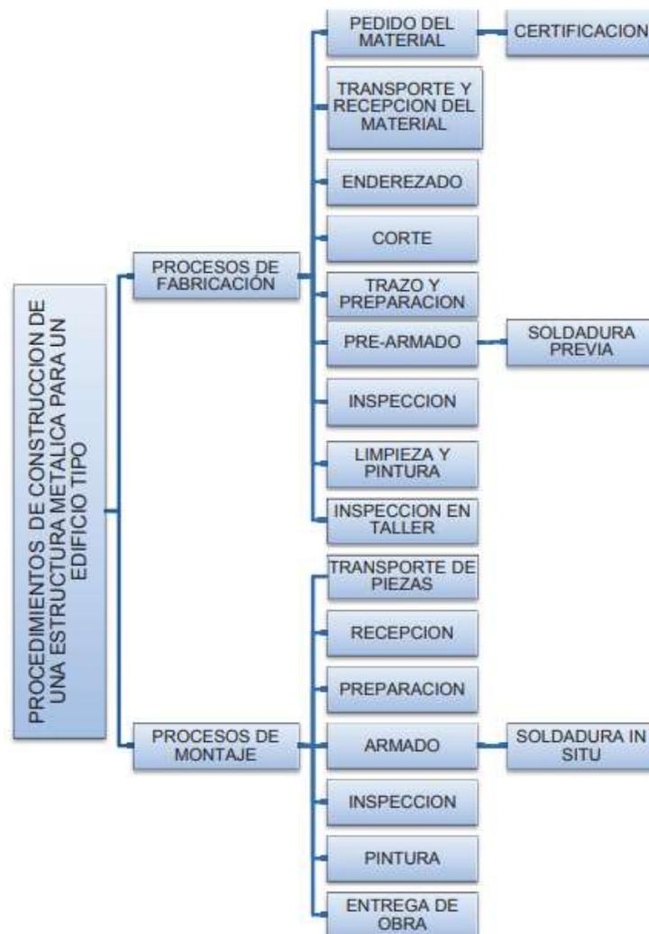
Figura 18. Proceso de Fabricación y montaje.
