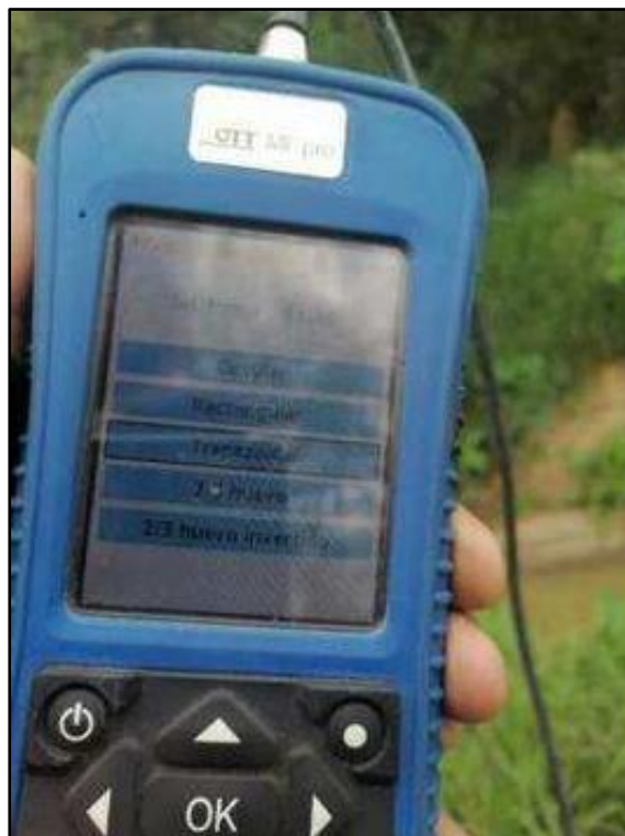
Imagen 26: Seleccionamos el tipo de canal La sección de principio a fin es de sección trapezoidal.
