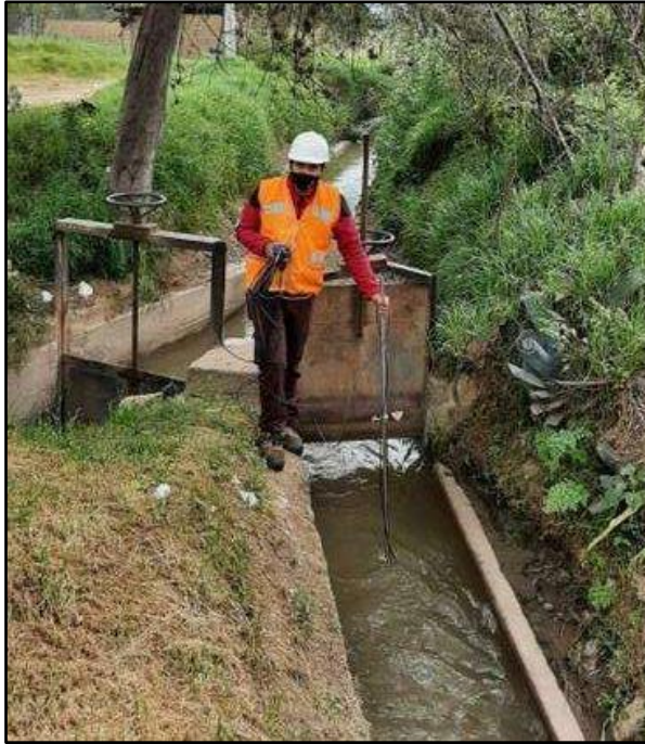
Imagen 41: Realizando mediciones en el Canal lateral de primer orden N° 01 Obteniendo datos de caudal en el primer canal lateral de primer orden N° 01
