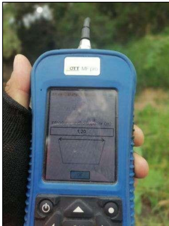
Imagen 27: Ingreso de datos geométricos (Ancho de canal)
