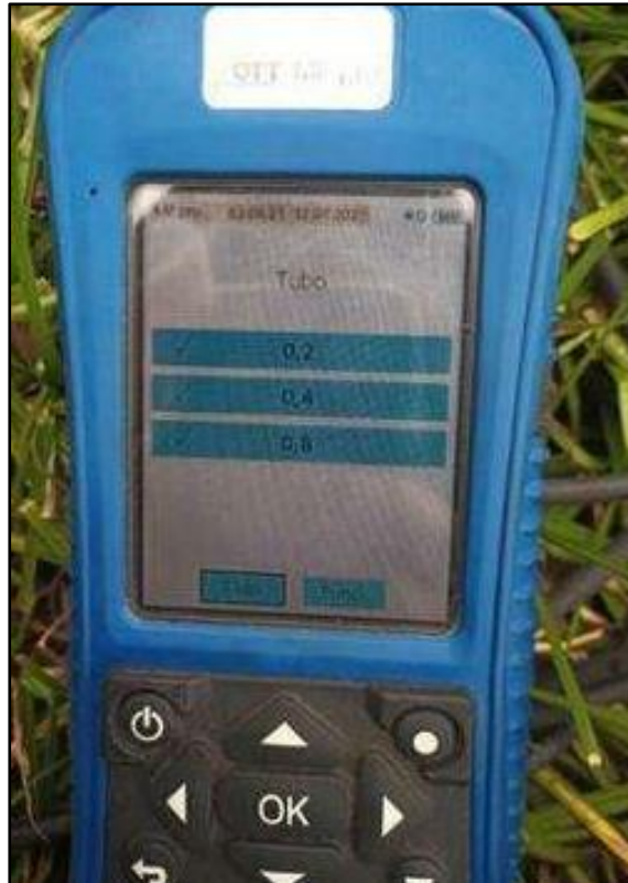
Imagen 30: Selección del método para determinar la velocidad y caudal. El método para usar es el 0,2 / 0,4 / 0,8, como se aprecia en la pantalla del correntómetro.
