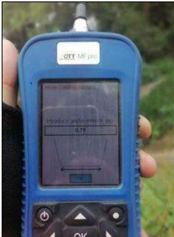
Imagen 29: Ingreso de datos geométricos (Base menor) La base menor del canal trapezoidal es de 75 centímetros.
