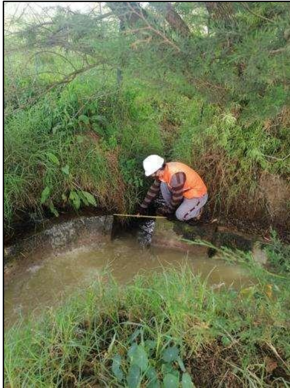
Imagen 36: Ingreso de aguas residuales de la PTAR al canal de riego la Collpa El canal de riego es abastecido por las aguas residuales de la PTAR de la ciudad e Cajamarca.
