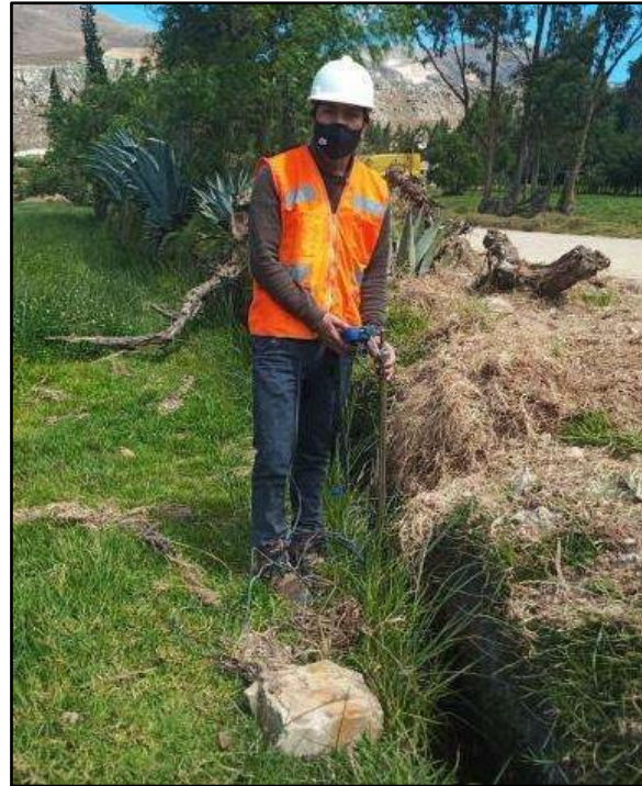
Imagen 44: Realizando mediciones de caudal y velocidad en tramos sin revestir.
