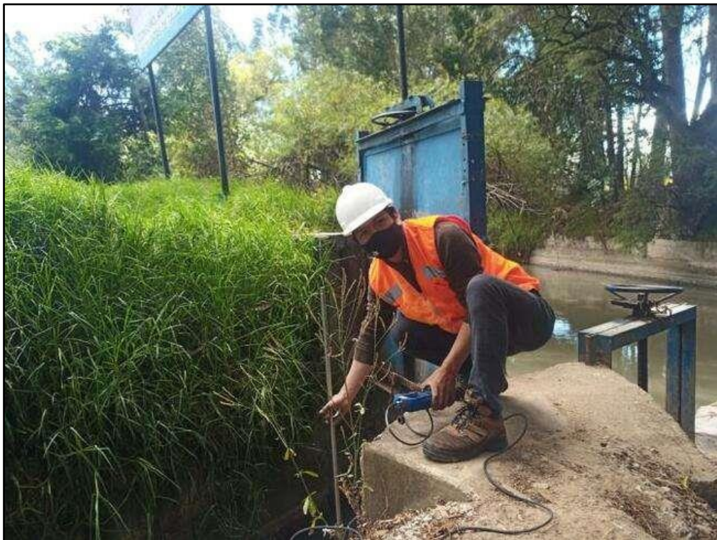
Imagen 08: Medición de caudal y velocidad con el uso del equipo (Correntómetro).
