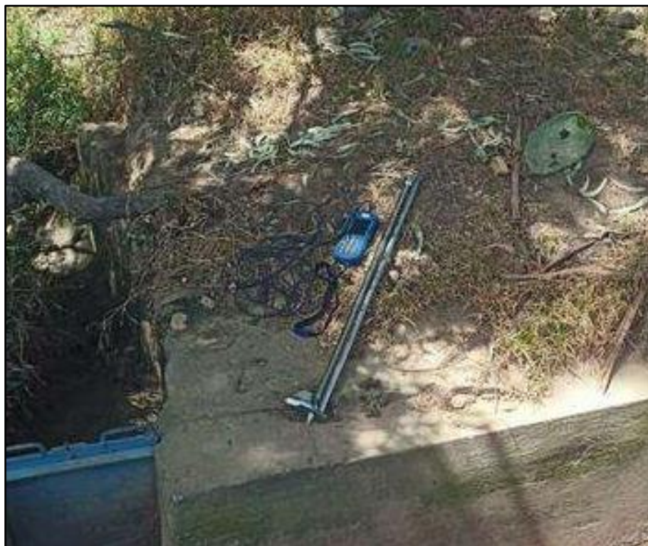
Imagen 10: Equipo para medir caudal (Correntómetro) Se observa el equipo usado para la medición de caudal.
