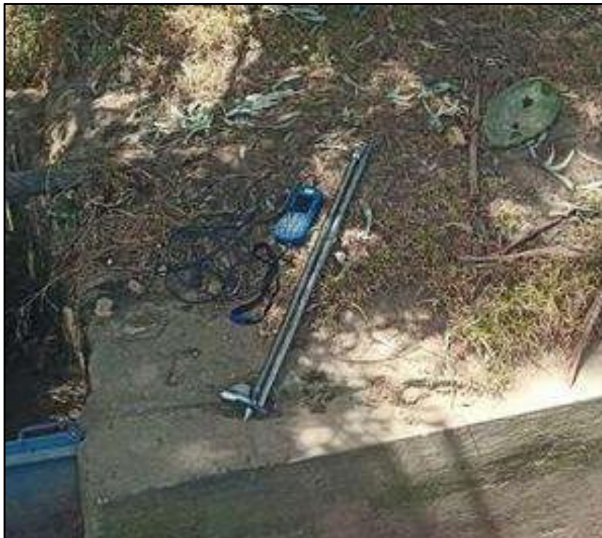
Imagen 03: Se muestra el correntómetro; equipo que fue usado para determinar el caudal y la velocidad del recurso hídrico que abastece al canal La Collpa.
