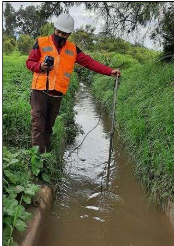
Imagen 83: Se observa el tipo de flujo turbulento. Se observa un tipo de flujo turbulento en parte del canal.
