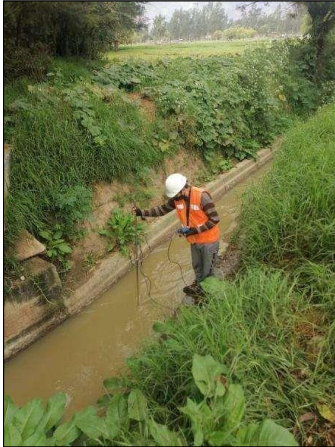
Imagen 25: Realizando mediciones de caudal estanque disipador Recopilando datos de caudal entre el estanque disipador y el canal de derivación principal.
