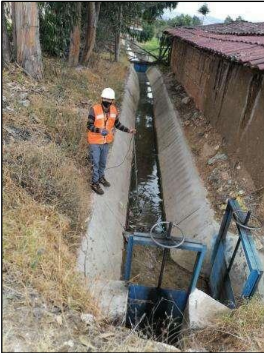
Imagen 43: Realizando mediciones de caudal y velocidad.
