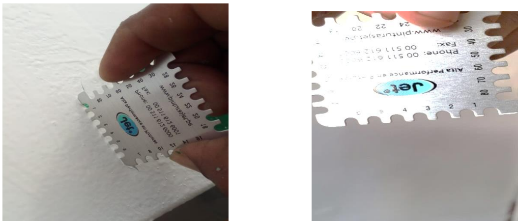
Figura 6: Control de espesor de película de pintura en muros Fuente: Empresa
