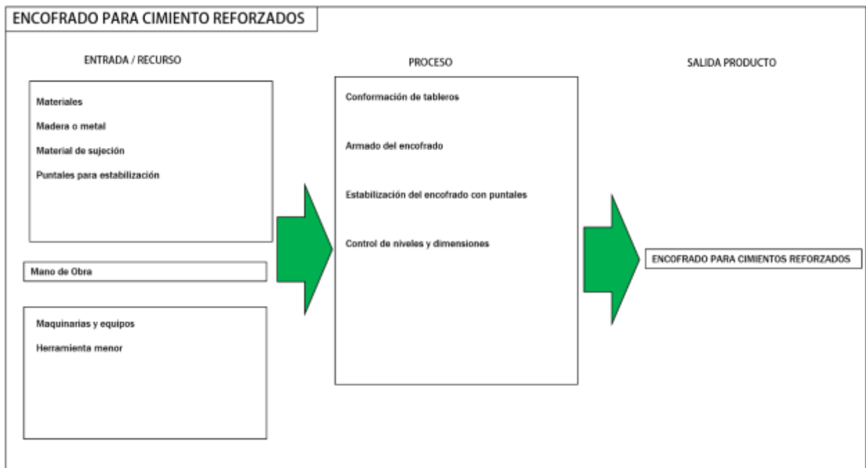
Figura 13. Encofrado de cimientos reforzados
