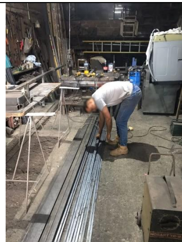
NO UTILIZA EPP COMPLETO Y MATERIAL EN DESORDEN.
