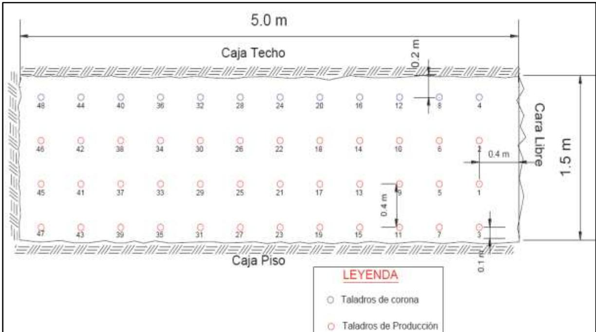
**Anexo N° 13: Método de Explotación Long Wall; Distribución y secuencia de salida de los taladros**
