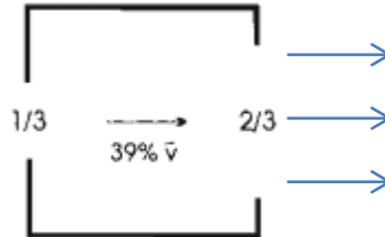
Figura n.º 05 Abertura 2/3 con Respecto al Muro
