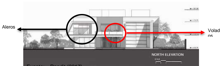
Figura n.º 22 Protección solar - Abhyuday
