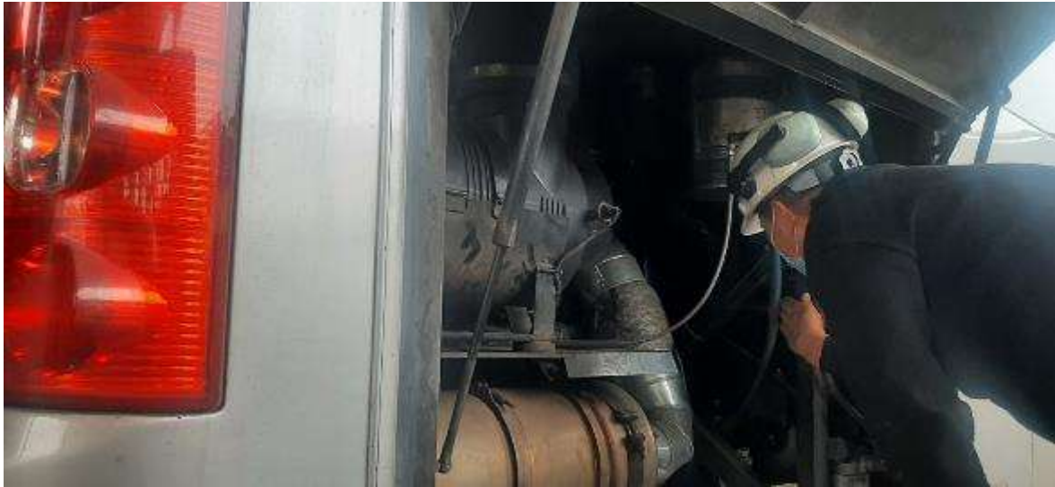
Figura 2. Técnico revisando el sistema de microfiltración Puradyn
