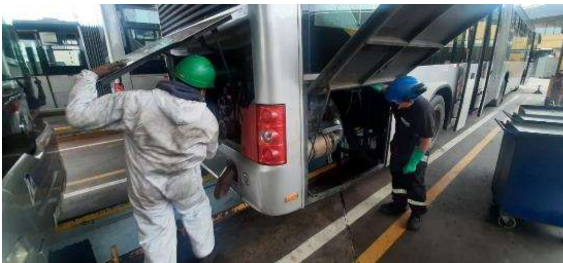
Figura 6. Proceso de mantenimiento mediante sistema de microfiltración
