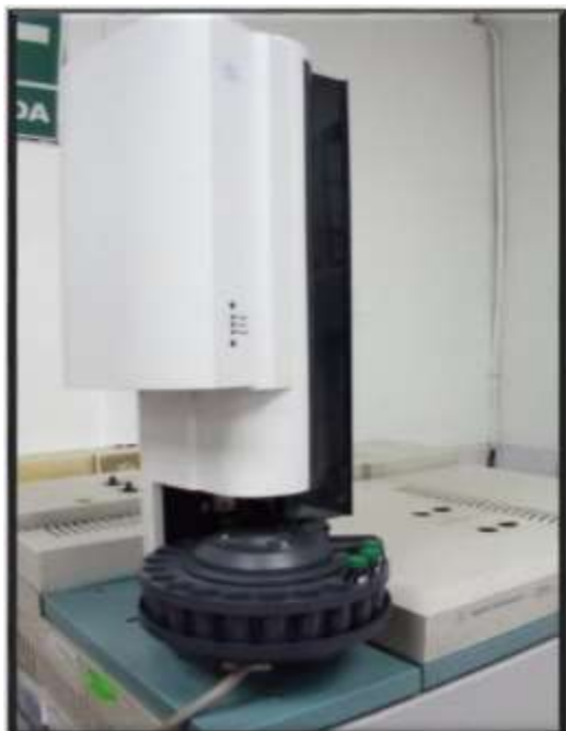
Figura N° 39 Autosampler - Porta Viales
